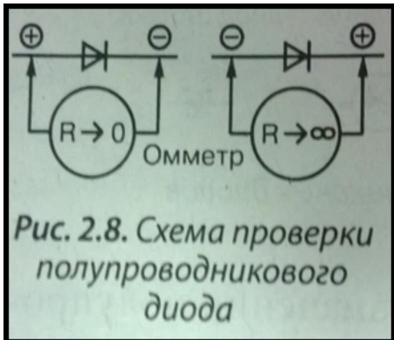
Рис. 2.8. Схема проверки полупроводникового диода
