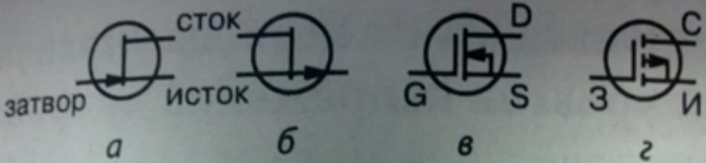
*Рис. 2.14. Условно-графические обозначения полевых транзисторов:
