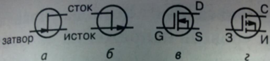
*Рис. 2.14. Условно-графические обозначения полевых транзисторов:
