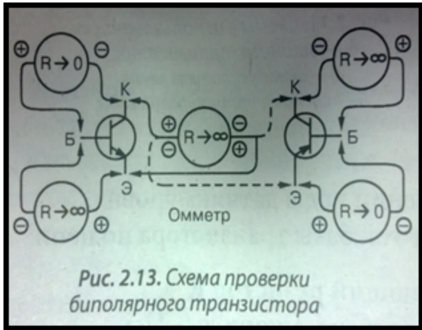
*Рис. 2.13. Схема проверки биполярного транзистора*
