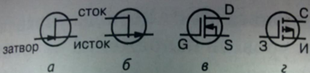
*Рис. 2.14. Условно-графические обозначения полевых транзисторов:*
