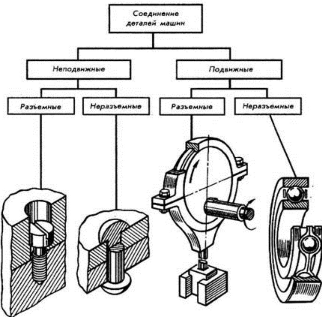
Каждый из этих двух типов соединений подразделяют на две основные группы: разъемные и неразъемные. **Разъемными** называются такие соединения, которые позволяют производить многократную сборку и разборку сборочной единицы без
