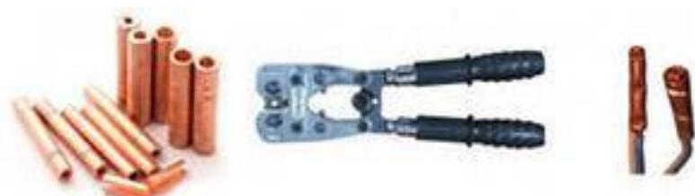
Способ опрессовка происходит так: оголенные концы проводов заводятся в медную или алюминиевую трубку и обжимают специальным инструментом, пресс-клещи. Диаметр трубы подбирайте в зависимости от общего сечения проводов. Проследите, чтобы провода входили плотно. Тогда надежность соединения будет лучше.
