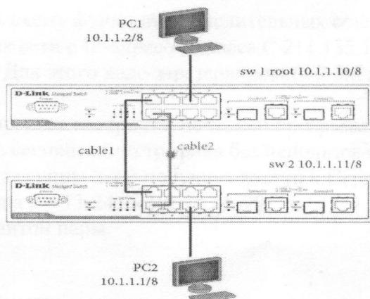
3. Настройка VLAN на основе меток: Создайте VLAN v2 и v3, назначьте нетэгированные порты соответствующим VLAN (v2 нетегированные 1-24, тегированный 25, v3 нетегированные 26-28, тегированный 25). Проверить доступность узлов.
