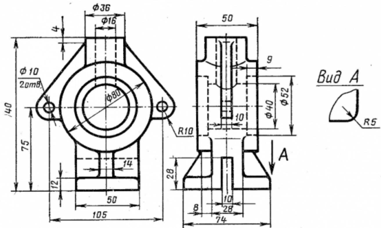
Построить ассоциативный чертеж 3D модели Стойки с необходимым числом видов, разрезов, сечений.
