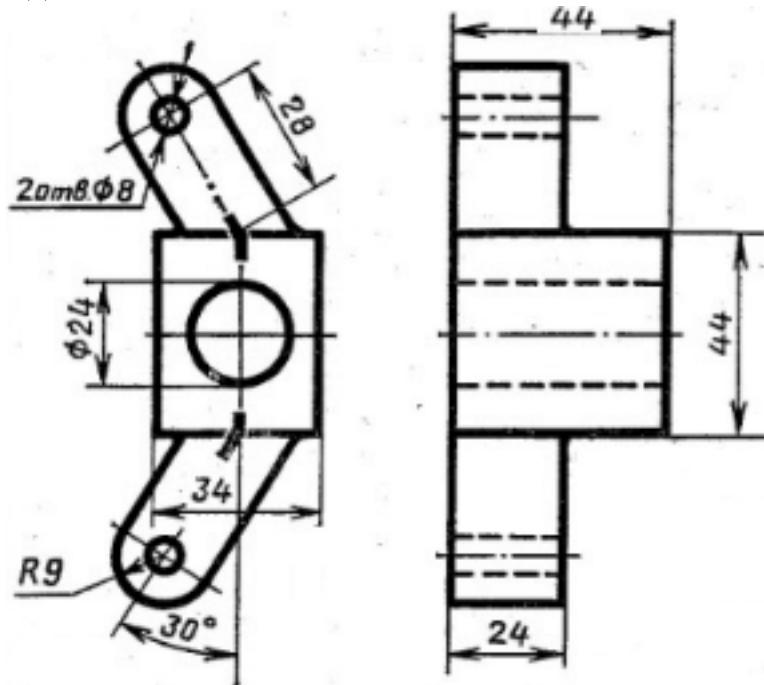
Построить 3D модель детали Распорка используя команды редактирования: Обрезать, Удлинить, Повернуть, Перенос;
