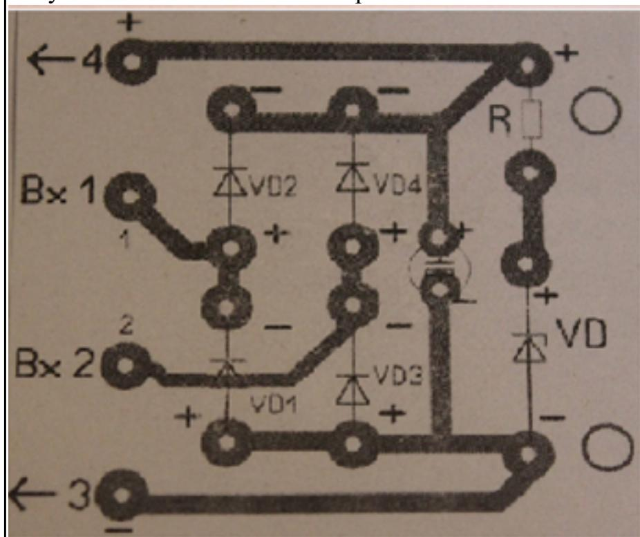
Рисунок 3. Размещение радиоэлементов на печатной хеме выпрямителя.
