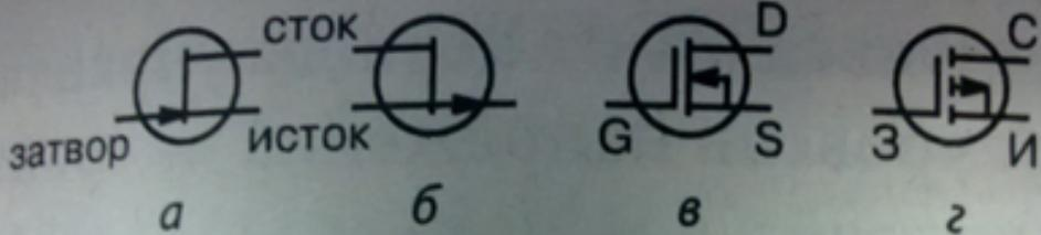
*Рис. 2.14. Условно-графические обозначения полевых транзисторов:*
