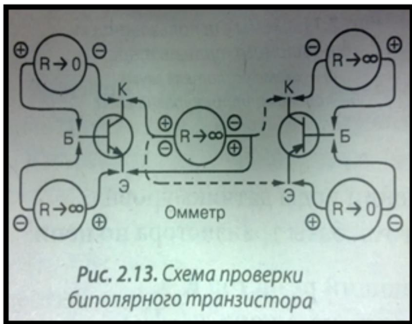
*Рис. 2.13. Схема проверки биполярного транзистора*
