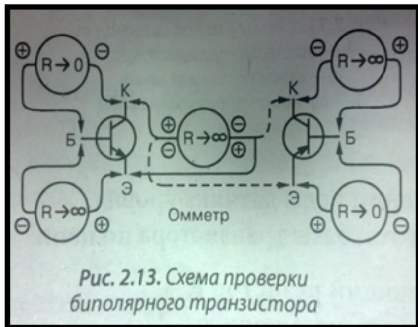
*Рис. 2.13. Схема проверки биполярного транзистора*
