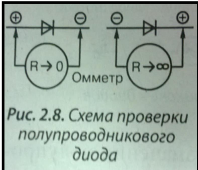
*Рис. 2.8. Схема проверки полупроводникового диода*
