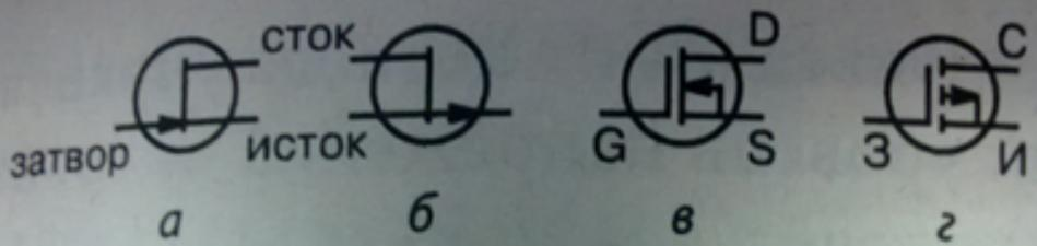
*Рис. 2.14. Условно-графические обозначения полевых транзисторов:*
