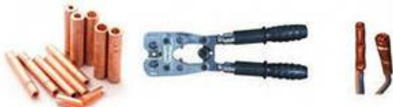
Способ опрессовка происходит так: оголенные концы проводов заводятся в медную или алюминиевую трубку и обжимают специальным инструментом, пресс-клещи. Диаметр трубы подбирайте в зависимости от общего сечения проводов. Проследите, чтобы провода входили плотно. Тогда надежность соединения будет лучше.
