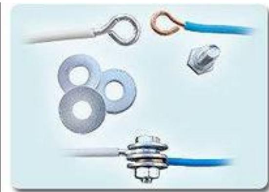
Как мы уже выяснили выше, способ пайки является самым надежным видом соединения проводов. Но имеет и недостатки – цельность полученных соединений. Для того, чтобы соединение можно было как соединять, так и разъединять, применяется, наверное, самый распространенный способ соединения проводов. Им является резьбовой, то есть, с помощью болтов и гаек. Маленький совет: при резьбовом способе не забывайте почаще протягивать метизы для плотного соединения проводов.
