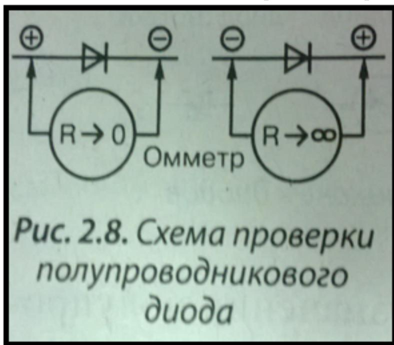
*Рис. 2.8. Схема проверки полупроводникового диода*
