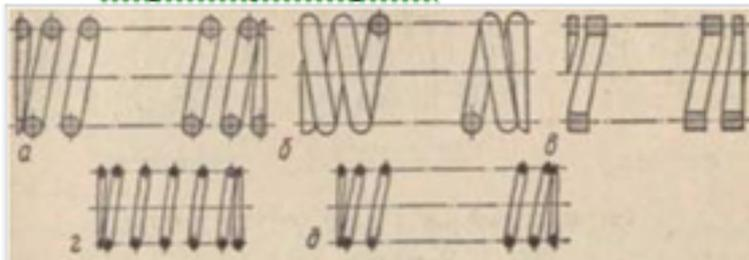
Для цилиндрических винтовых пружин из материала круглого сечения, работающих на сжатие или на растяжение, на поле рабочего чертежа надлежит указывать следующие данные:
