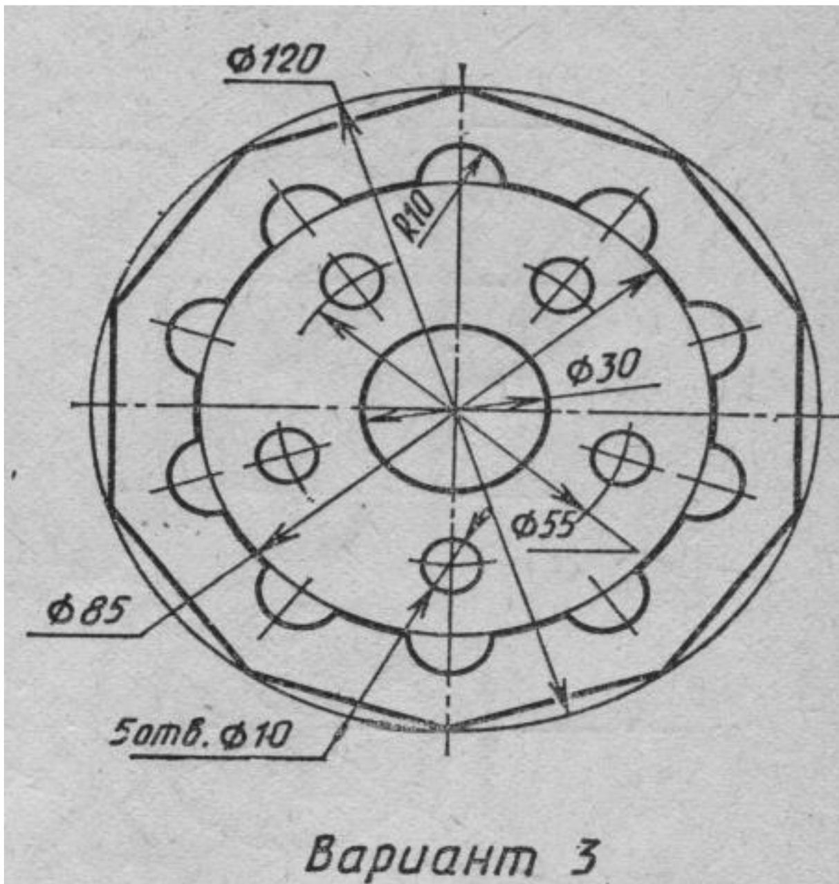
Вычертить контур плоской детали с элементами деления окружности, сопряжений, нанесением размеров.
