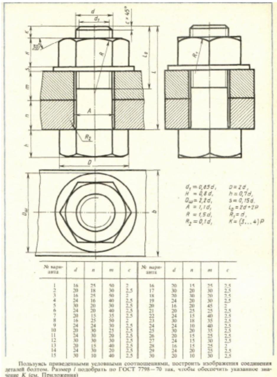
Построить изображение соединения деталей болтом. Размер  $L$  подобрать по ГОСТ 7798-70 так, чтобы обеспечить указанное значение  $K$ . При диаметре болта менее 20 мм построения выполнять в М 2:1, а при диаметре более 24 мм – в М 1:1
