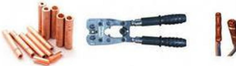
Способ опрессовка происходит так: оголенные концы проводов заводятся в медную или алюминиевую трубку и обжимают специальным инструментом, пресс-клещи. Диаметр трубки подбирайте в зависимости от общего сечения проводов. Проследите, чтобы провода входили плотно. Тогда надежность соединения будет лучше.
