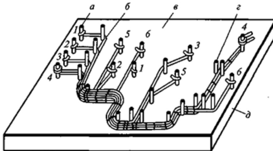
Рис. 1.26. Шаблон для укладки и вязки жгутов:
