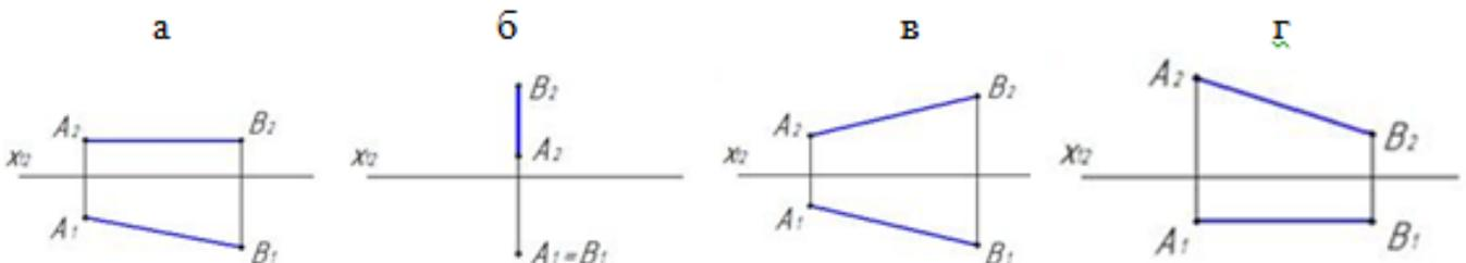
22. На каком чертеже проекции фронтально – проецирующей прямой?
