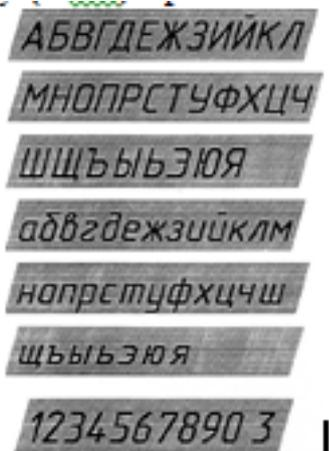
Первоначально надписи шрифтом рекомендуется выполнять с использованием сетки. Сетку строят тонкими, едва заметными линиями в следующей последовательности:
