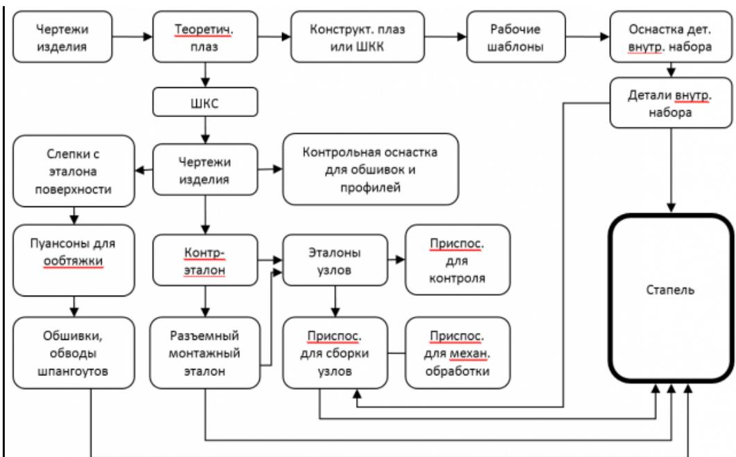
Составленная схема увязки для бесплазового метода
