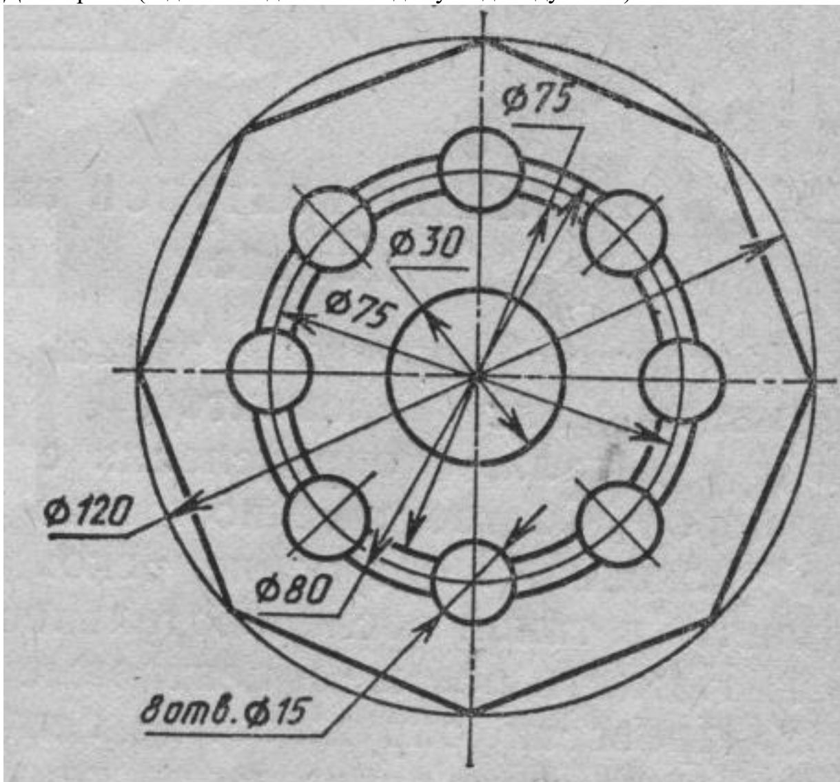
Вычертить контур плоской детали с элементами деления окружности, сопряжений,
