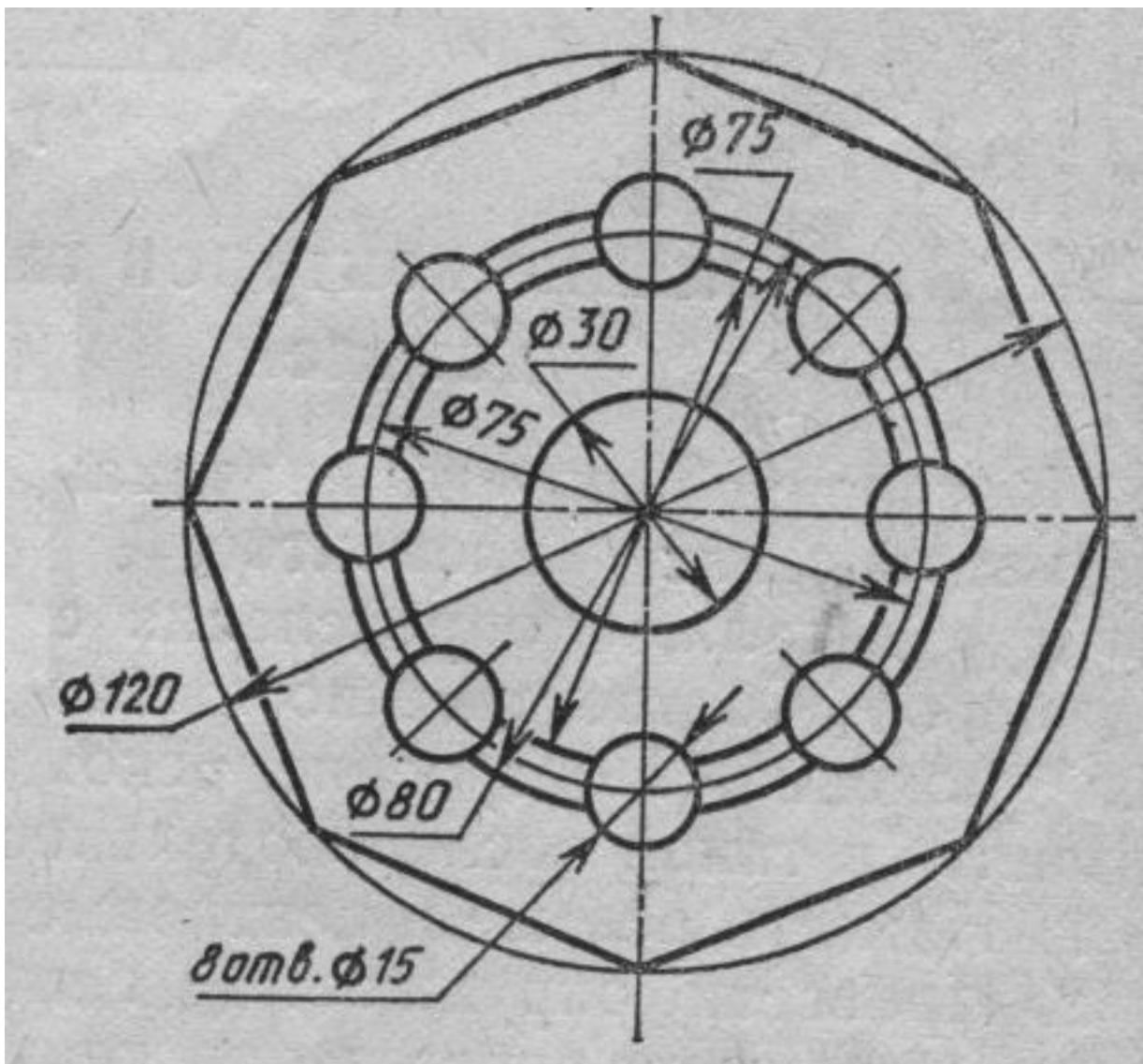
Вычертить контур плоской детали с элементами деления окружности, сопряжений, нанесением размеров.
