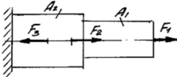
Определить характер нагружения и вид деформации каждого участка приведенного бруса, пользуясь построенными ранее эпюрами нормальных напряжений. (Приведен один из вариантов заданий)
