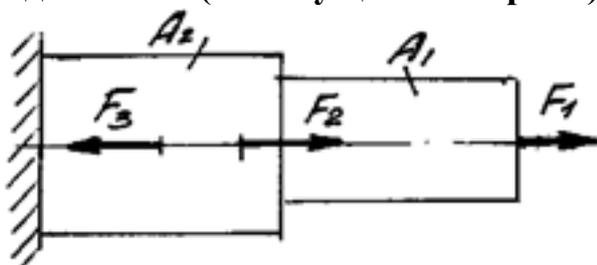
Определить характер нагружения и вид деформации каждого участка приведенного бруса, пользуясь построенными ранее эпюрами нормальных напряжений. (Приведен один из вариантов заданий)
