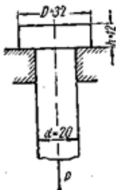
Выяснить, соблюдаются ли условия равнопрочности стержня на растяжение, его головки на срез и опорной поверхности головки на смятие, если  $[\sigma_p] = 120$  Н/мм<sup>2</sup>;  $[\tau_{ср}] = 70$  Н/мм<sup>2</sup>;
