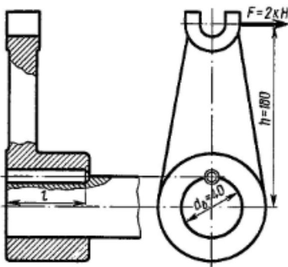
Вильчатый кривошип укреплен на валу с помощью цилиндрической шпонки и нагружен, как показано на рисунке. Определить из расчёта на прочность по смятию требуемый диаметр шпонки, если  $l = 3.5 d$ ;  $[\sigma]; [\sigma]_{см} = 85 \text{ Н/мм}^2$
