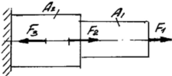
Выполнить расчетна прочность и жесткость каждого участка приведенного бруса, пользуясь построенными ранее эпюрами нормальных напряжений. (Приведен один из вариантов заданий)
