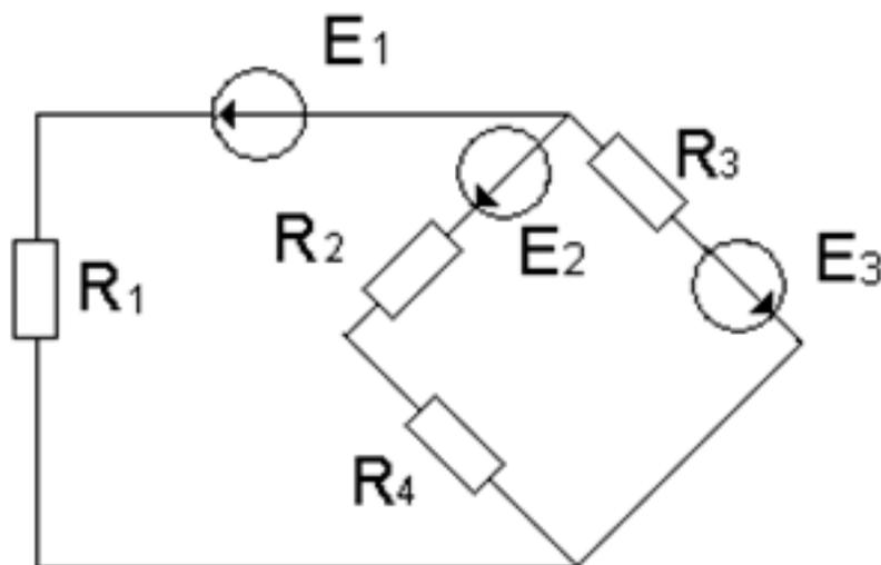
По заданной схеме электрической цепи определить какими методами можно рассчитать данную цепь. По структурному анализу схемы определить количество уравнений составленных: по методу законов Кирхгофа, по методу контурных токов и по методу узловых напряжений. Составить независимые уравнения при решении задачи методом законов Кирхгофа, применив правила составления уравнений.
