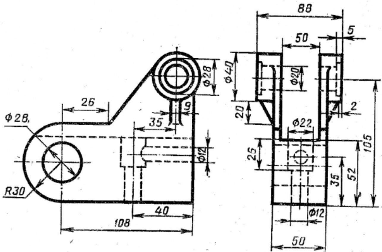
По приведенным изображениям детали построить модель и ассоциативный чертеж, с выполнением необходимых разрезов, сечений и нанесением размеров.
