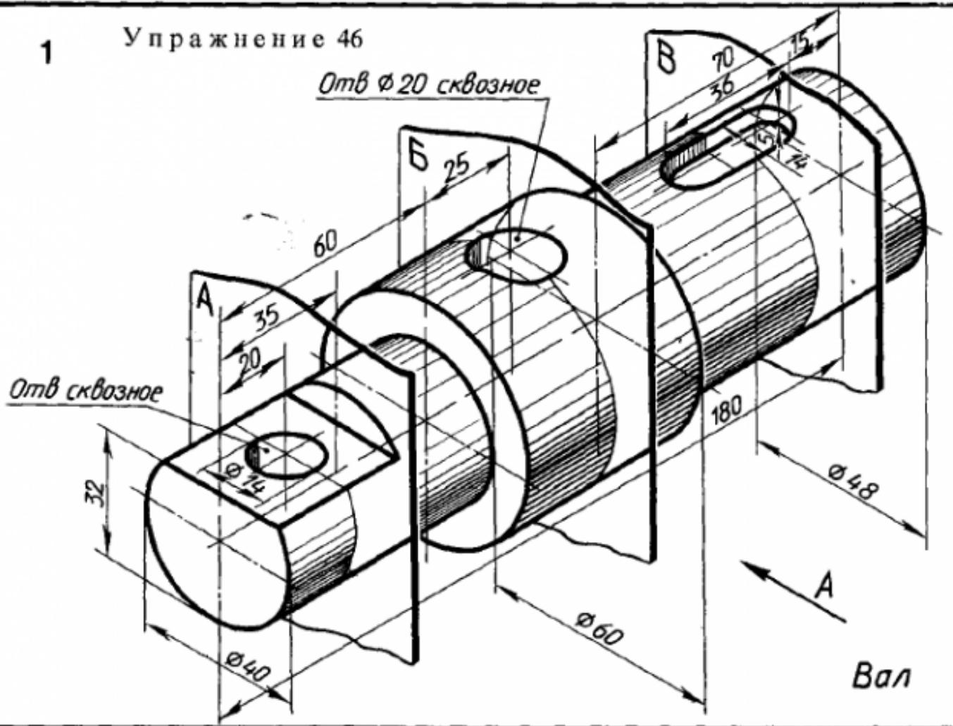
Построить ассоциативный чертеж детали типа Вал с выполнением необходимых разрезов, сечений и нанесением размеров.
