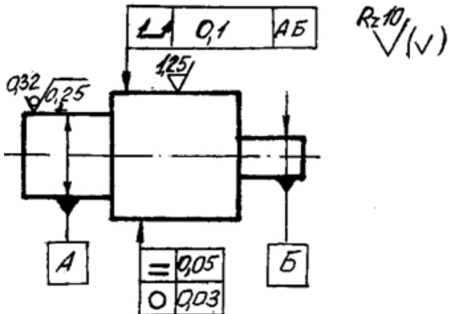
2. Точность формы поверхностей деталей: виды отклонений формы, обозначение отклонений формы на чертежах. Расшифровать знаки отклонений формы, взаимного расположения и шероховатости поверхности
