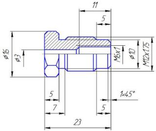
и на его основе произвести *выбор токарного инструмента* для обработки данной детали. Выбрать резцы для *черновой, чистовой обработки и сверлильный инструмент*, а так же сопутствующую *инструментальную оснастку и данные для расчета режимов резания*. Выбор производится из каталога фирмы Sandvik Coromant для токарного инструмента.
