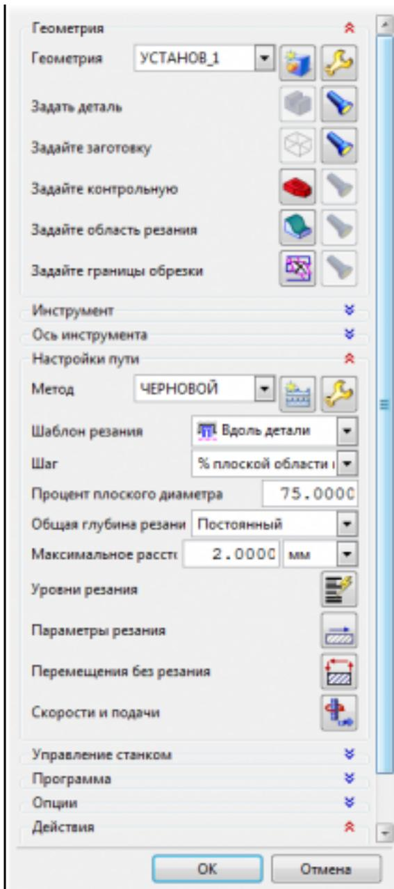
Определение шаблона резания.
