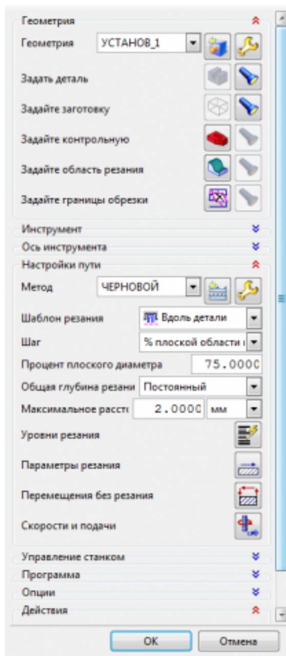
1. Определение шаблона резания
