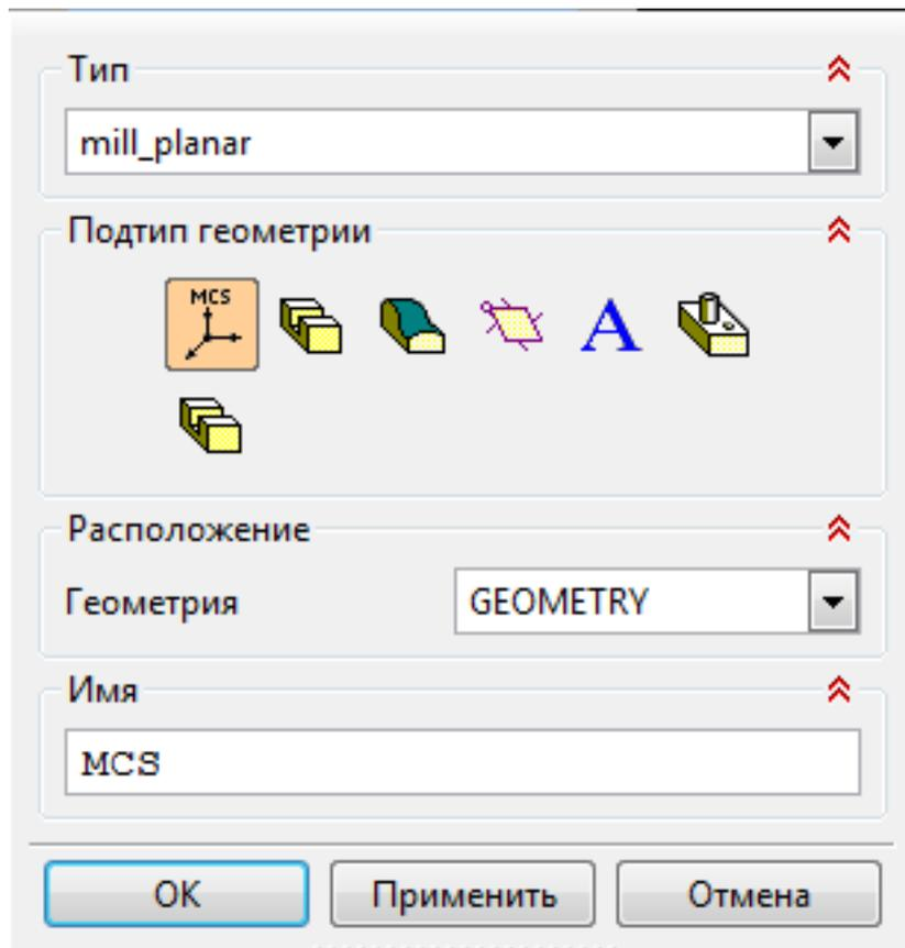
1. Назначение геометрии заготовки.
