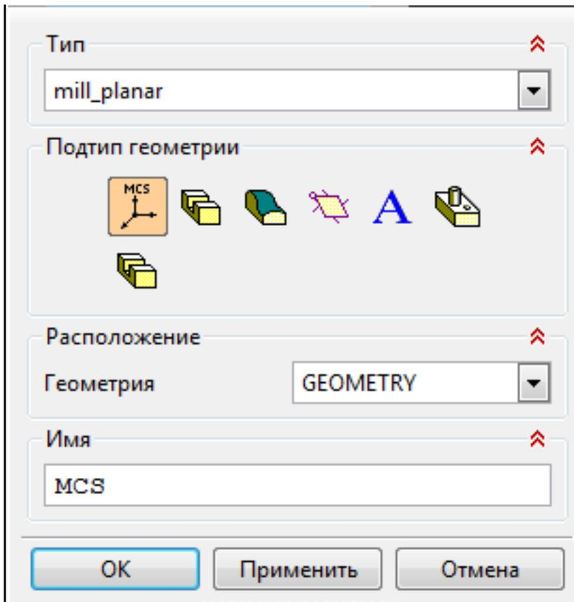
Назначение геометрии заготовки.
