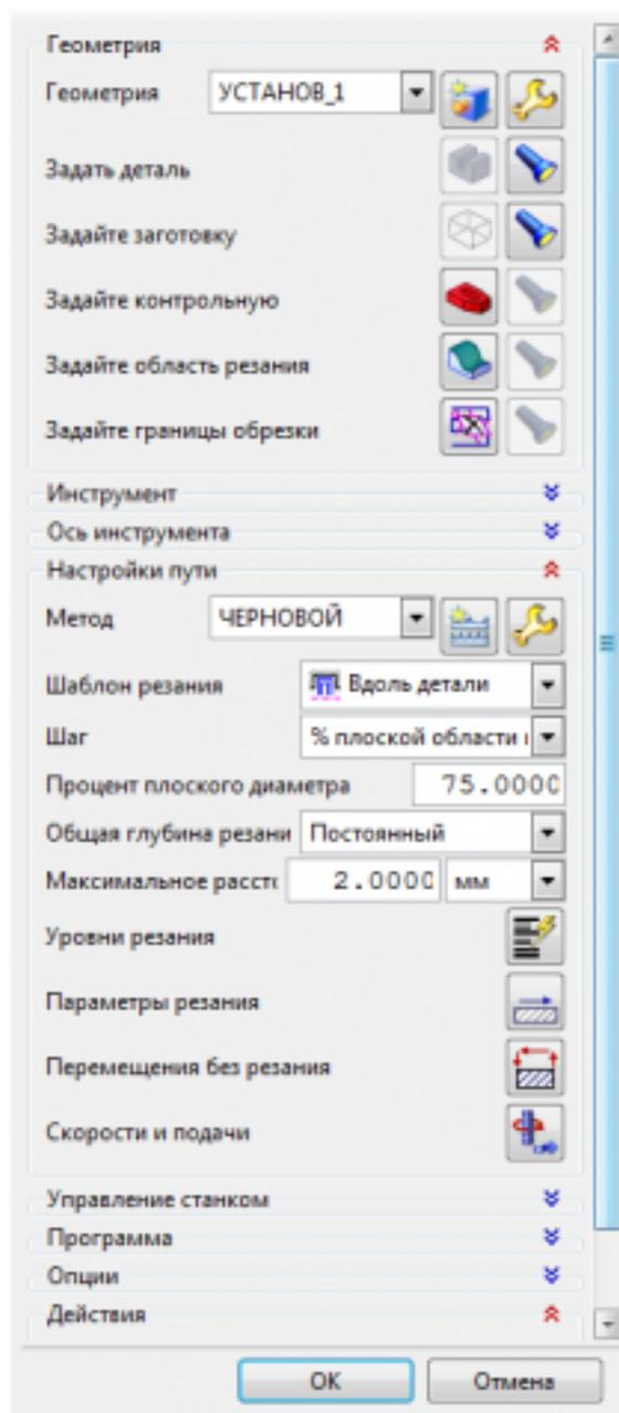
1. Определение шаблона резания
