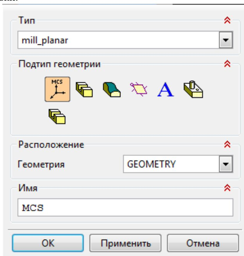
1. Назначение геометрии заготовки.
