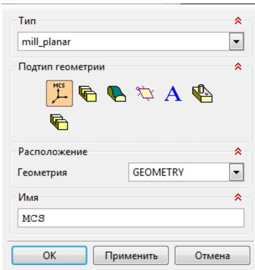
1. Назначение геометрии заготовки.
