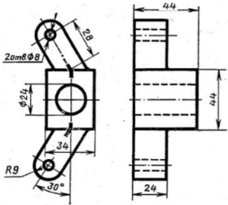
Построить 3D модель детали Распорка используя команды редактирования:
