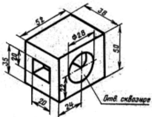
Построить 3D модель детали используя команды редактирования: Обрезать, Удлинить, Повернуть, Перенос;
