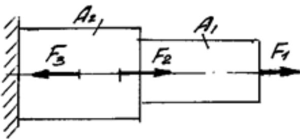
Определить характер нагружения и вид деформации каждого участка приведенного бруса, пользуясь построенными ранее эпюрами нормальных напряжений. (Приведен один из вариантов заданий)
