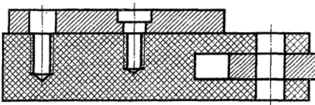
Указать какие детали соединяются болтом, какие шпилькой, какие винтом.
