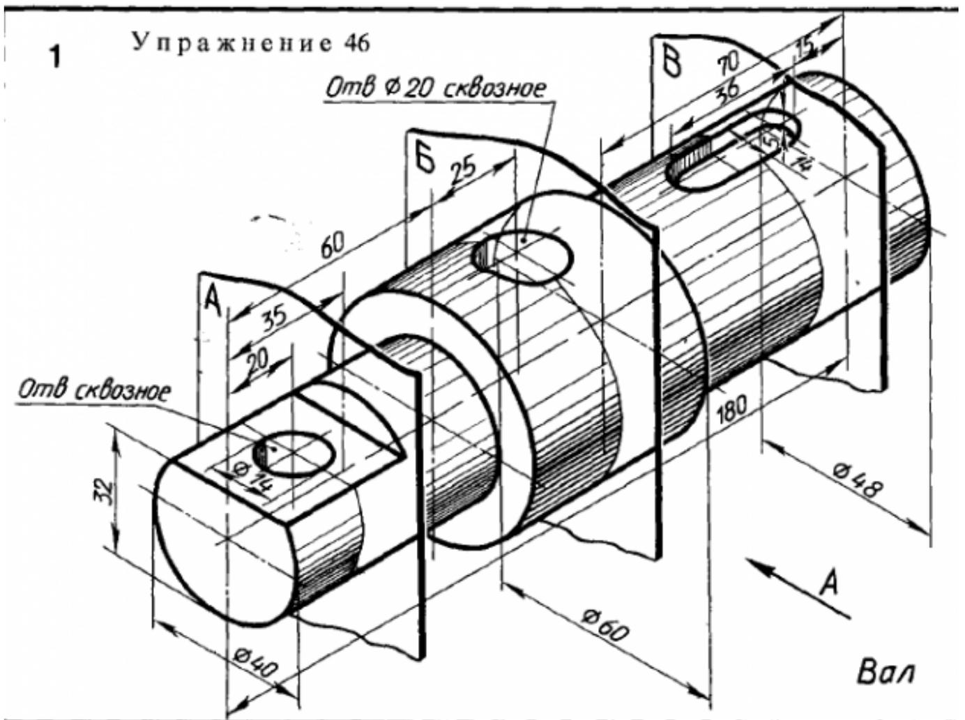
Построить ассоциативный чертеж детали типа Вал с выполнением необходимых разрезов, сечений и нанесением размеров.
