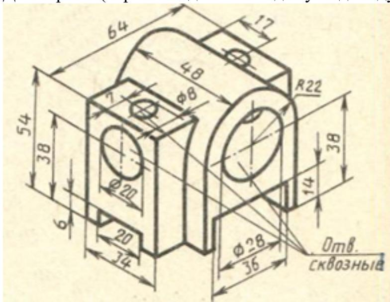
Построить 3D модель и задать свойства детали (наименование детали, выбрать материал детали) в дереве модели.
