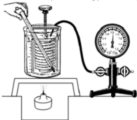
— сильфон (прибор, при помощи которого можно изменять объем воздуха; сильфон подключается к манометру);
