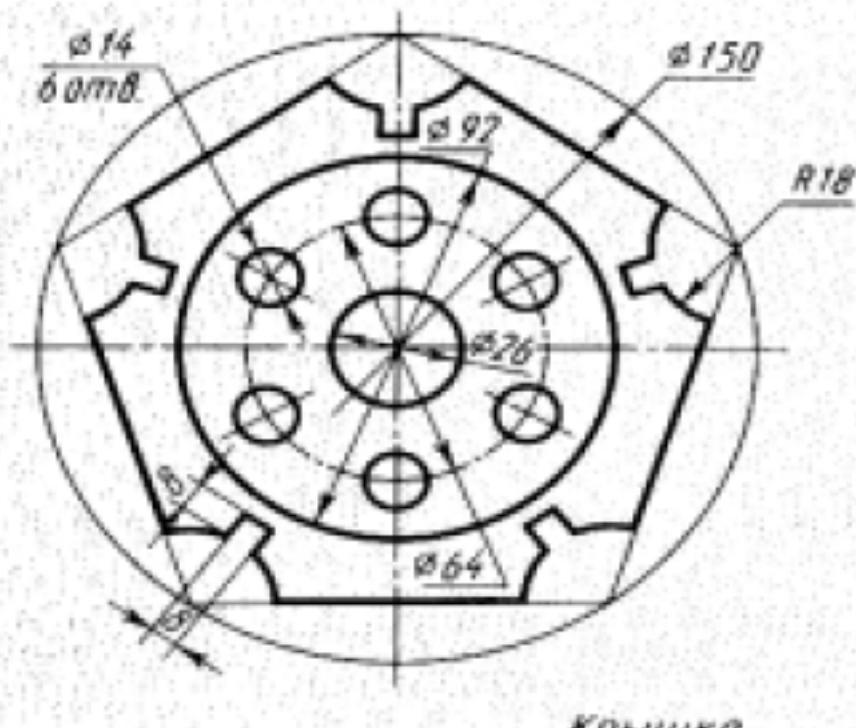
Вычертить контур плоской детали с элементами деления окружности, сопряжений, нанесением размеров.
