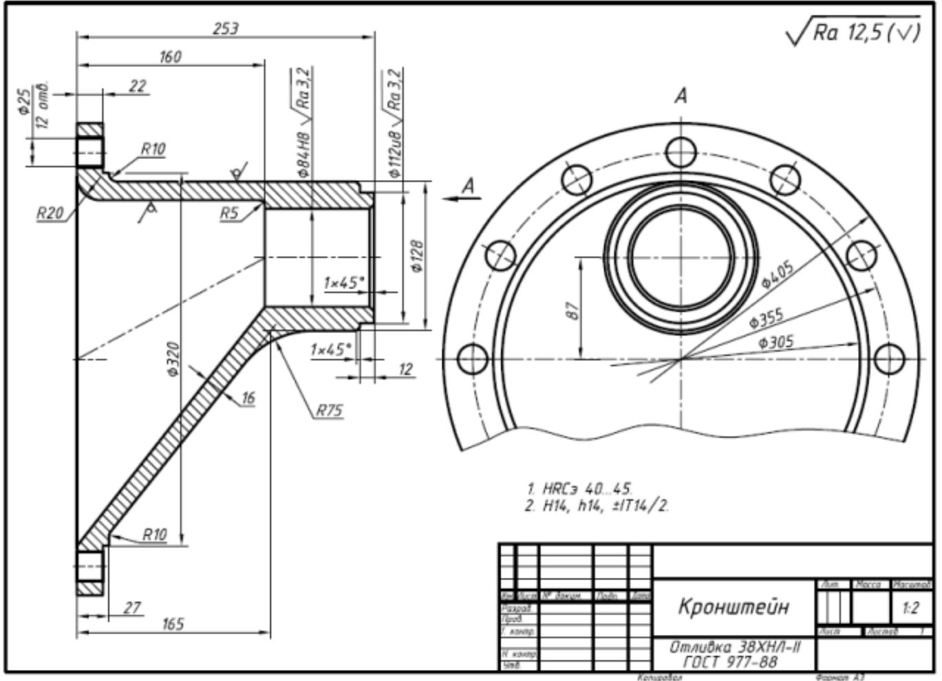
Дан чертеж. Создайте 3D модель, назначьте свойства детали, нанесите размеры.
