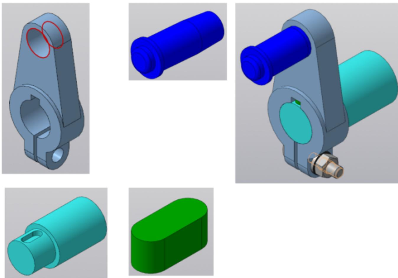
Даны детали, входящие в сборку узла "Кривошип". Соберите 3D модель сборки "Кривошип" и сформируйте спецификацию.
