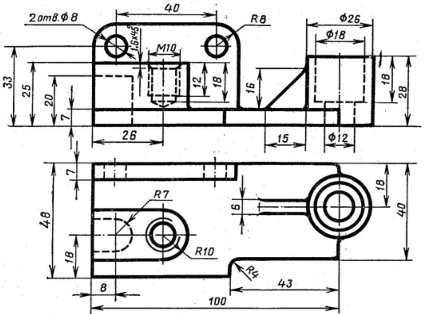
Дан чертеж. По двум проекциям постройте твердотельную 3D модель с применением инструментов панелей «Элементы тела», приложения «Библиотека стандартных элементов». На 3D модели нанесите размеры.
