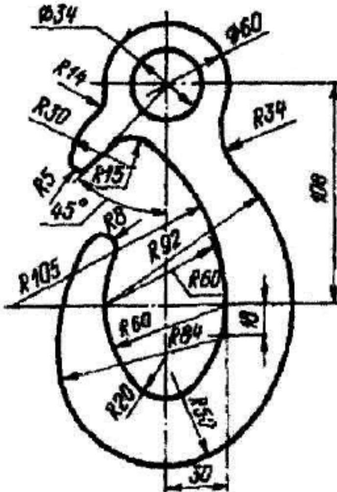
Дан чертеж. Постройте очертания контура плоской детали. Нанести размеры.
