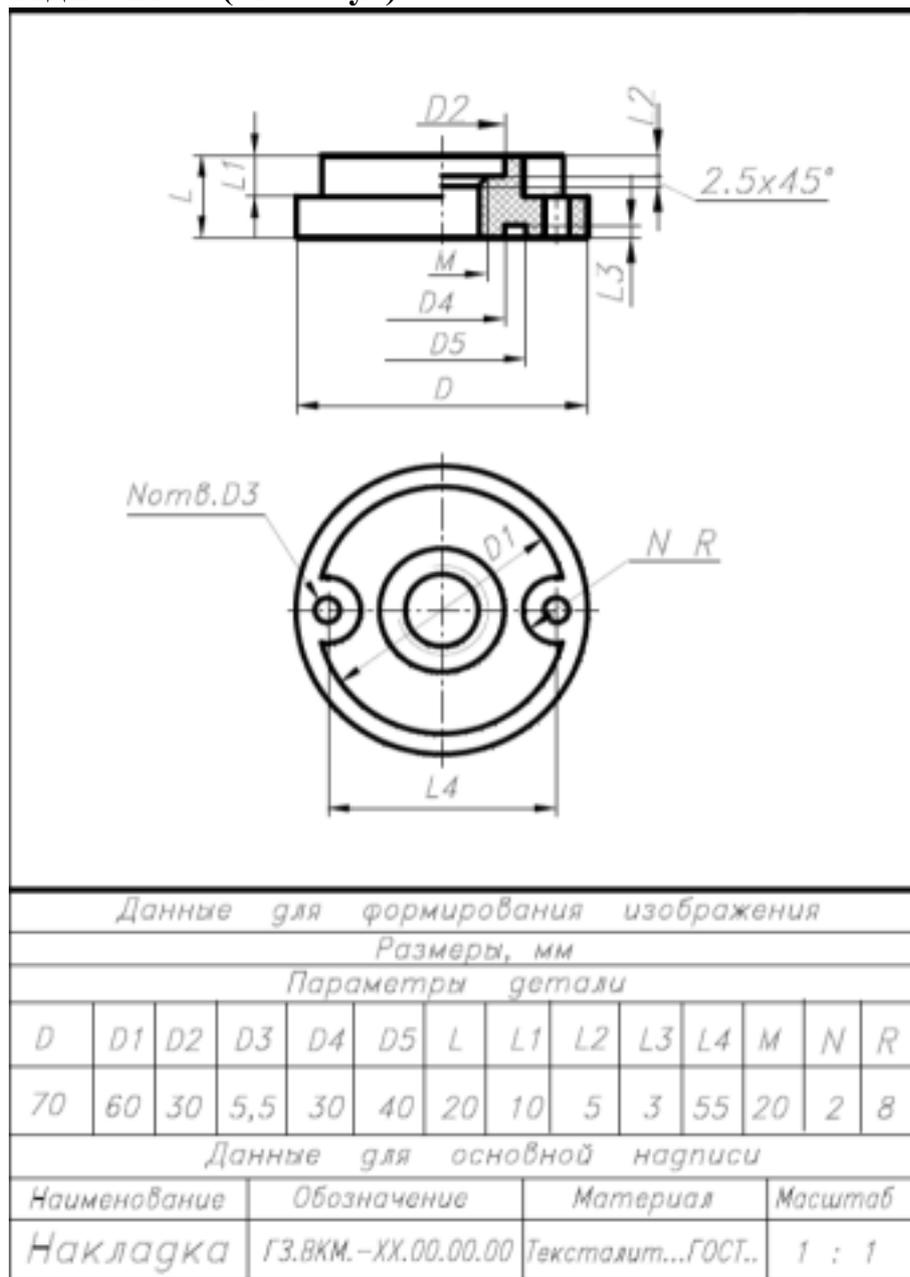
Дан чертеж. Постройте твердотельную модель тела вращения (по вариантам) с применением инструментов панелей «Элементы тела» (вращение), "Размеры". Постройте ассоциативный чертеж с выполнением требований ГОСТов 2-109-73 и 2.307-2011.
