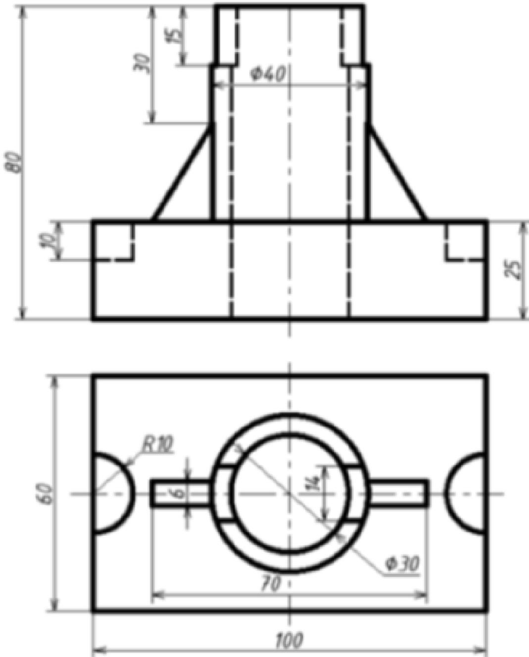
Дан чертеж . Постройте 3D модель с применением операций Ребро жесткости, Отверстие. На 3D модели нанесите размеры.
