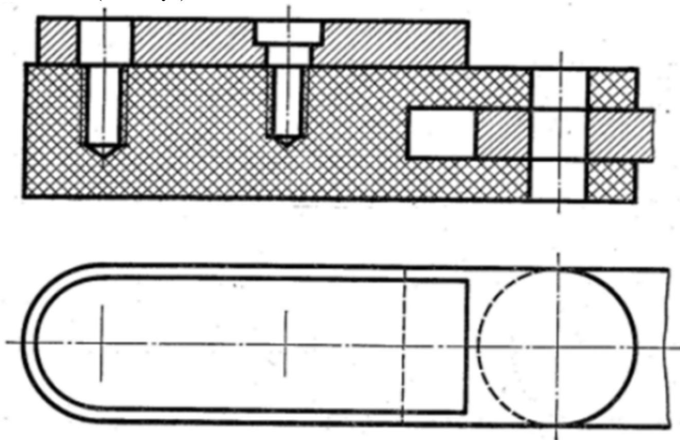
Дан чертеж . Постройте сборку из деталей, соединив их шпилькой М10 (ГОСТ11765-66), винтом М8 (ГОСТ 17475-72) и болтом М12 (ГОСТ 7798-70). Учтите, что деталь, в которую заворачивается шпилька и винт выполнена из пластмассы.
