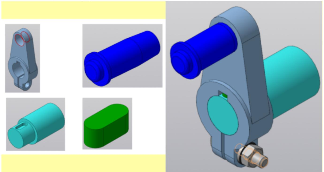
Даны детали, входящие в сборку узла "Кривошип". Соберите 3D модель сборки "Кривошип" и сформируйте спецификацию.
