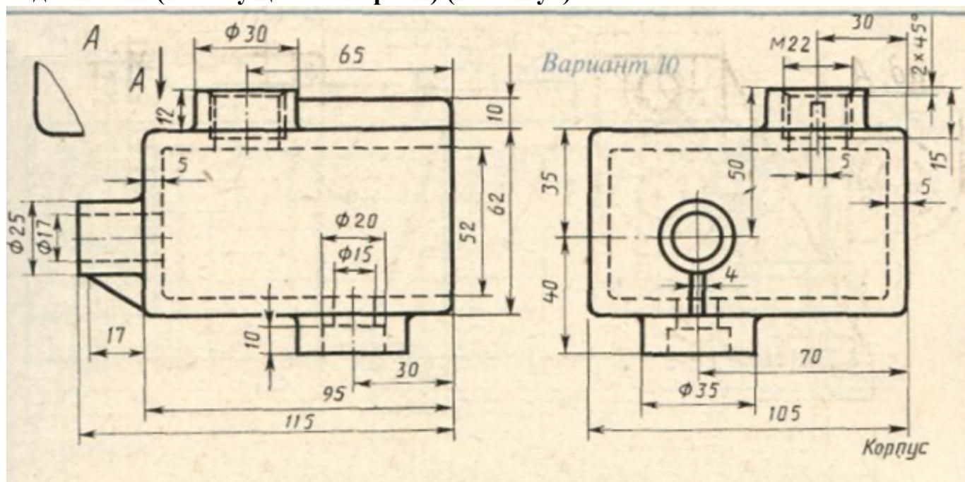
Дан чертеж. По двум проекциям постройте 3D модель с применением инструментов панелей «Элементы тела», "Массив, копирование", «Вспомогательные объекты», "Размеры".
