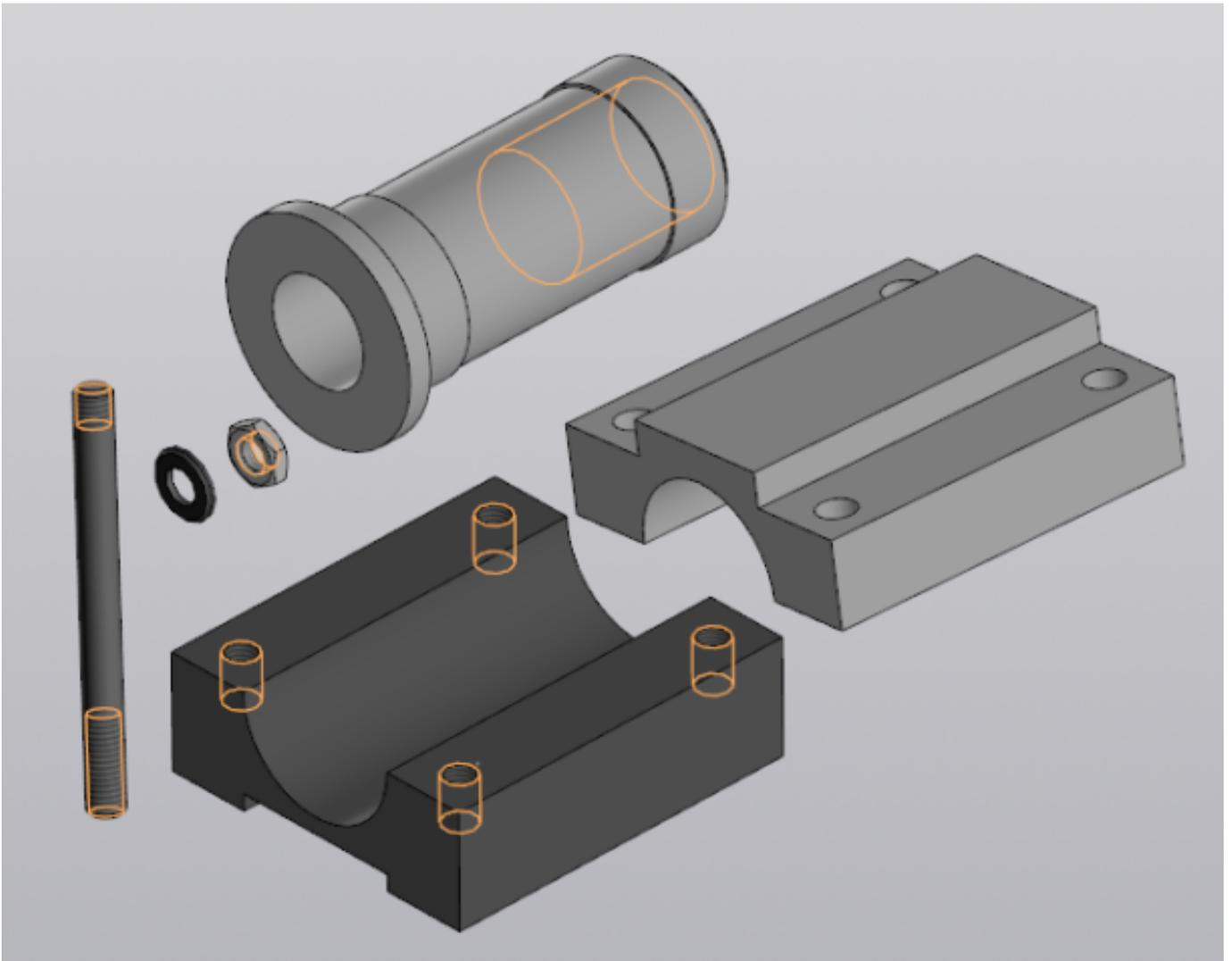
Выданы 3D модели деталей. Создайте сборочную единицу "Корпус в сборе" с применением стандартных крепежных изделий (шпилька ГОСТ22032; шайба ГОСТ 11371-78; гайка ГОСТ 5916-70), используя инструменты панели «Компоненты», «Размещение компонентов», «Диагностика».
