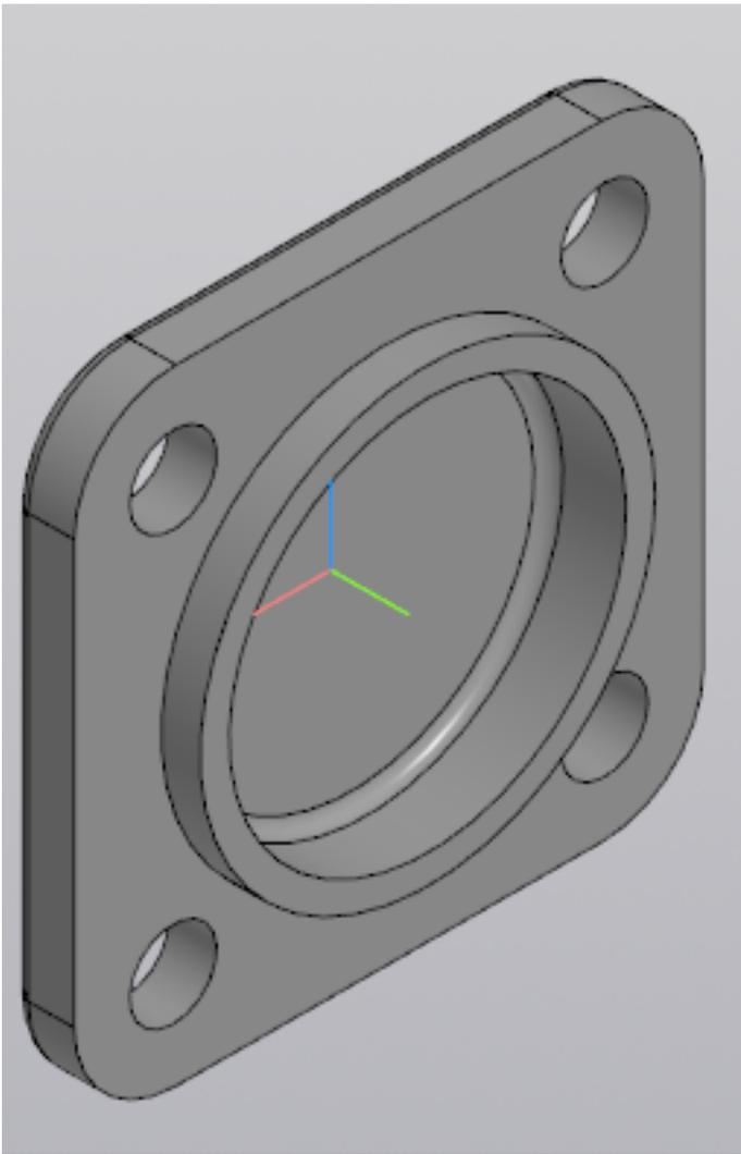
Постройте параметрическую модель детали Крышка торцевая, создав в таблице переменных не менее пяти наборов размеров.
