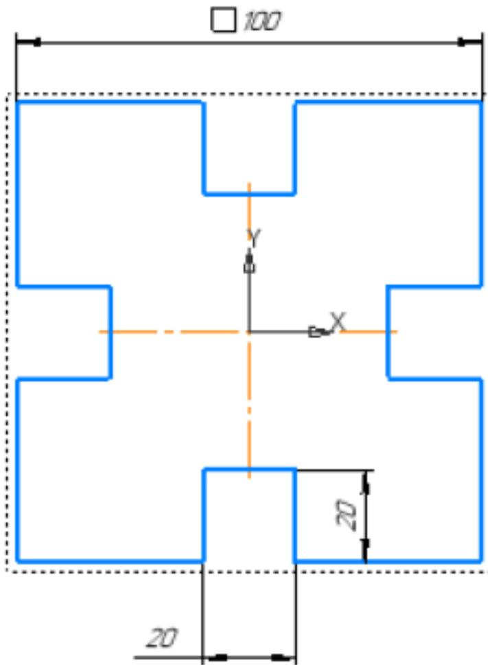
Создайте полностью определенный эскиз Плиты с пазами, исправив представленный контур, используя инструменты панели «Ограничения».
