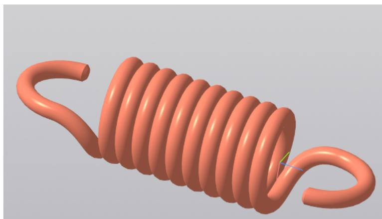
Постройте спираль цилиндрическую с применением операции по траектории (базовая плоскость XY, расположена в начале координат диаметр спирали 30 мм, количество витков 10, шаг 6 ).
