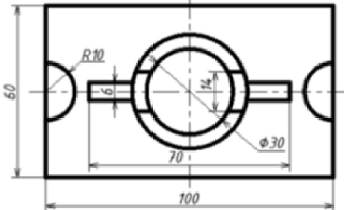
Дан чертеж (по вариантам). Постройте 3D модель с применением операций Ребро жесткости, Отверстие.
