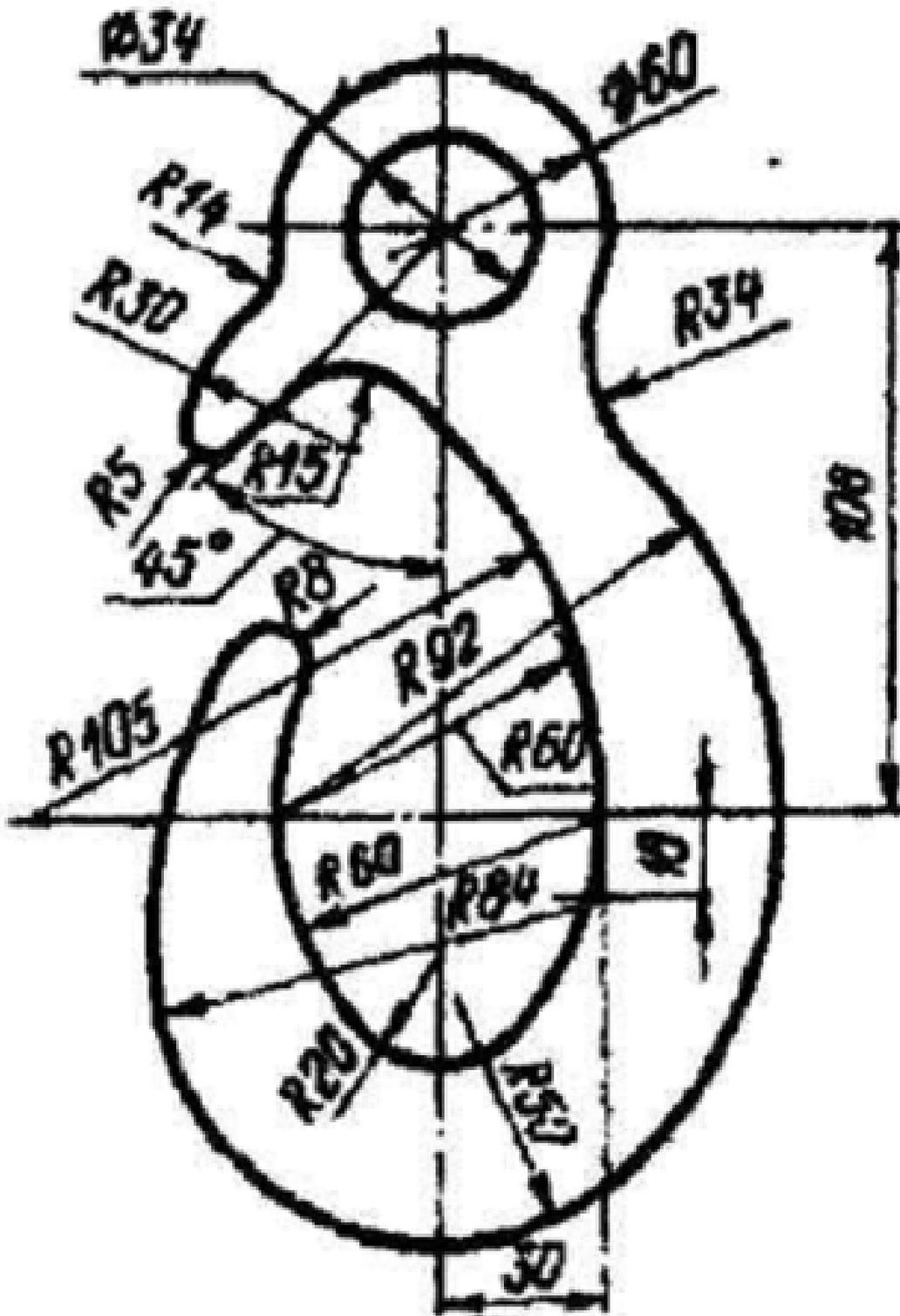
Дан чертеж (по вариантам). Постройте очертания контура плоской детали. Нанесите размеры.
