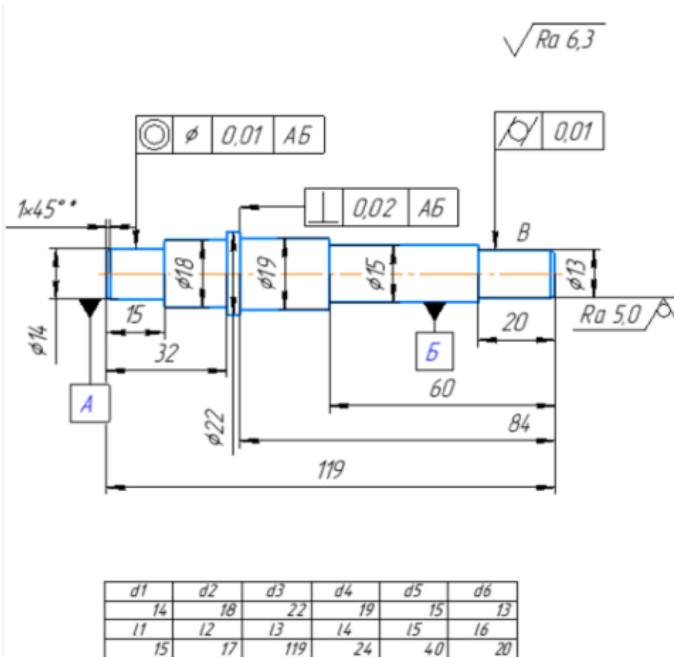
Дан образец. Создайте чертеж формата А3 горизонтальной ориентации, постройте вал, проставьте базы, шероховатости, создайте линий-выноски, с использованием инструментов панели "Обозначения».
