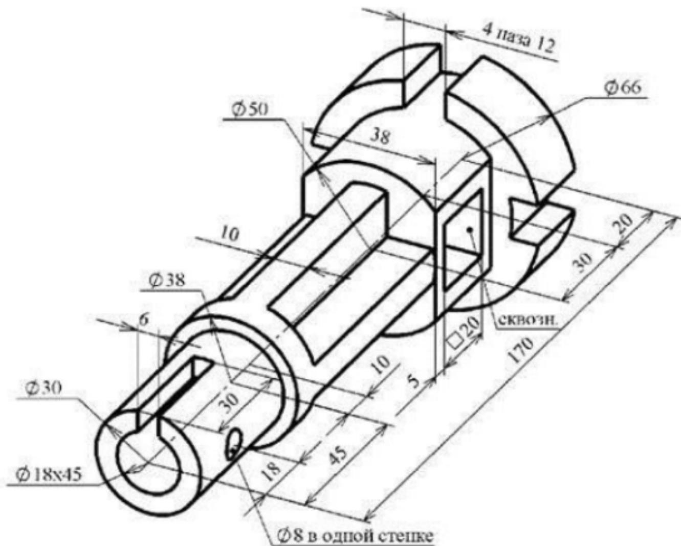
Дан чертеж. Постройте твердотельную модель тела вращения (согласно своему варианту) с применением инструментов панелей «Элементы тела» (вращение), на 3D модели нанести размеры.
