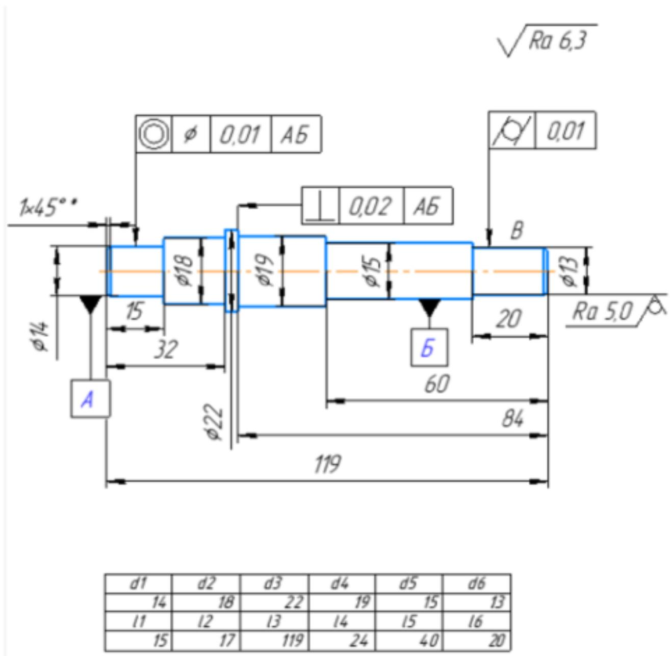
Дан образец. Создайте чертеж формата А3 горизонтальной ориентации, постройте вал, проставьте базы, шероховатости, создайте линий-выноски, с использованием инструментов панели "Обозначения».
