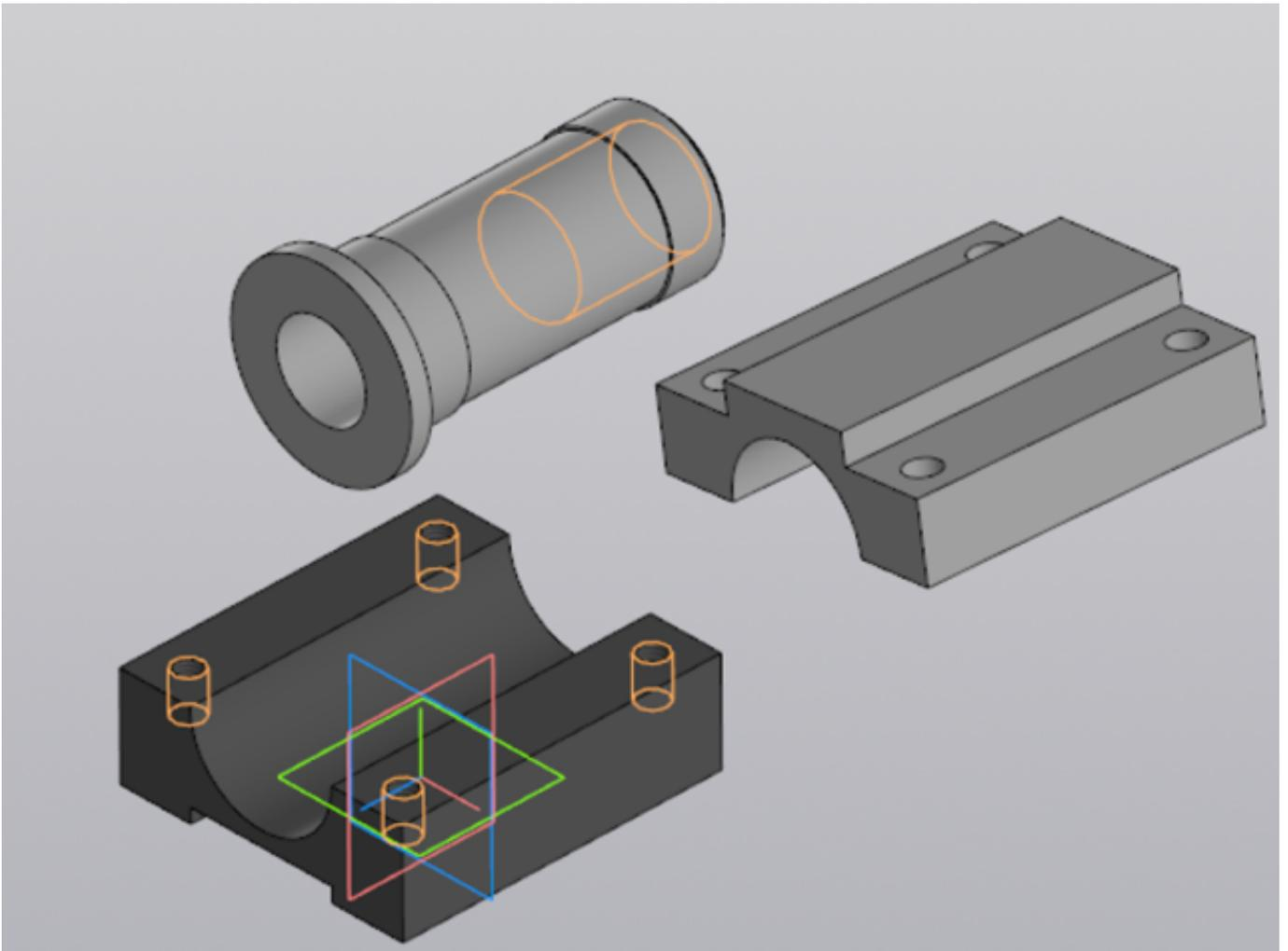
Выданы 3D модели деталей. Создайте сборочную единицу "Корпус в сборе", используя инструменты панели «Компоненты», «Размещение компонентов», «Диагностика».
