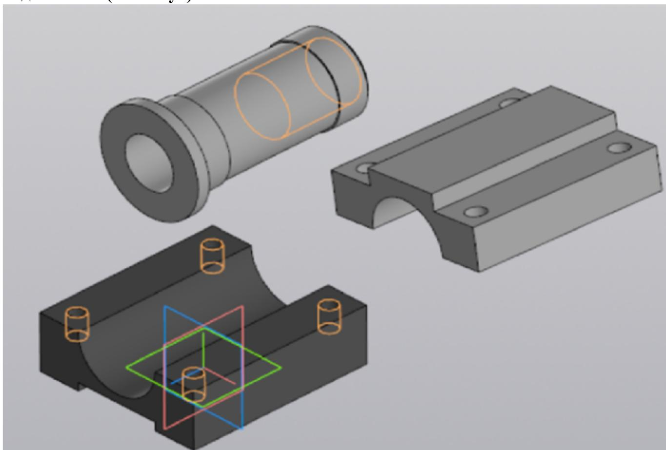
Создайте сборочную единицу "Корпус в сборе", с применением стандартных крепежных изделий (шпилька ГОСТ22032; шайба ГОСТ 11371-78; гайка ГОСТ 5916-70), используя инструменты панели «Компоненты», «Размещение компонентов», «Диагностика».
