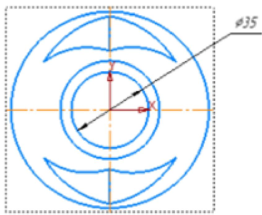
Дан чертеж. Постройте твердотельную модель с применением операции по сечениям.
