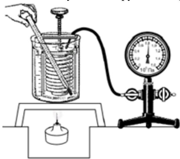
— сильфон (прибор, при помощи которого можно изменять объем воздуха; сильфон подключается к манометру);
