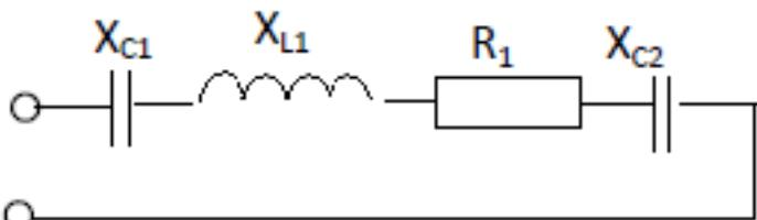
Дано:  $R_1=6 \text{ Ом}$ ;  $X_{C1}=2 \text{ Ом}$ ;  $X_{C2}=2 \text{ Ом}$ ;  $X_{L1}=12 \text{ Ом}$ ;  $U_{L1}=60 \text{ В}$ . Найти:  $Z$ ;  $I$ ;  $U$ ;  $\varphi$ ;  $P$ ;  $Q$ ;  $S$ .
