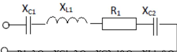
Дано:  $R_1 = 3 \Omega$ ;  $X_{C1} = 2 \Omega$ ;  $X_{C2} = 10 \Omega$ ;  $X_{L1} = 8 \Omega$ ;  $Q = -400 \text{ ВАр}$ . Найти:  $Z$ ;  $I$ ;  $U$ ;  $\varphi$ ;  $P$ ;  $S$ .
