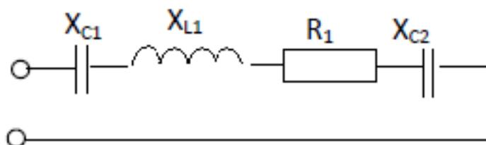
Дано:  $R_1=3 \text{ Ом}$ ;  $X_{C1}=2 \text{ Ом}$ ;  $X_{C2}=10 \text{ Ом}$ ;  $X_{L1}=8 \text{ Ом}$ ;  $Q=-400 \text{ ВАр}$ . Найти:  $Z$ ;  $I$ ;  $U$ ;  $\phi$ ;  $P$ ;  $S$ . Начертить в масштабе векторную диаграмму цепи.
