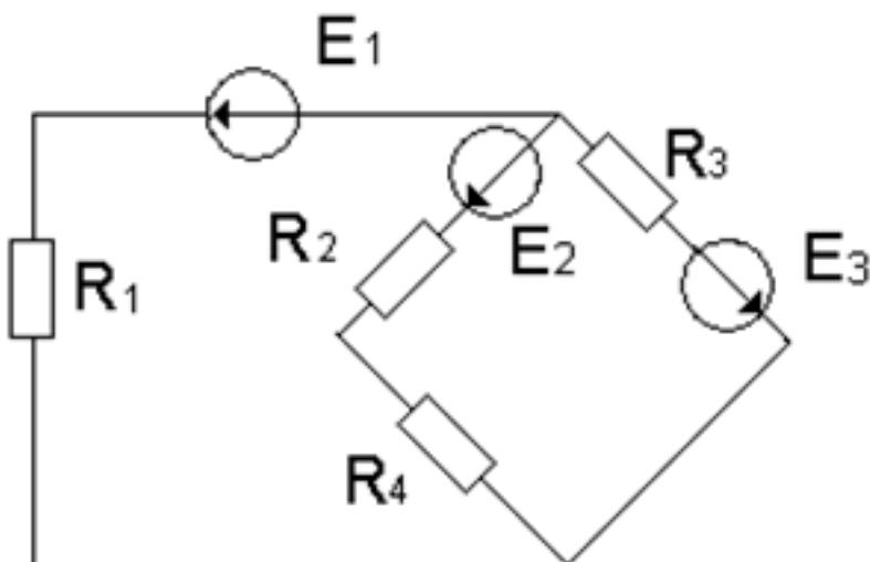
По заданной схеме электрической цепи: Определить число токов в схеме и выразить
