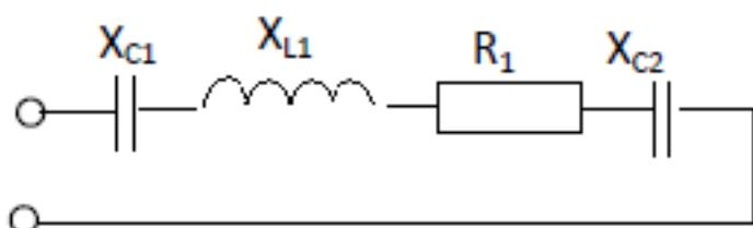
Дано:  $R_1=6 \text{ Ом}$ ;  $X_{C1}=2 \text{ Ом}$ ;  $X_{C2}=2 \text{ Ом}$ ;  $X_{L1}=12 \text{ Ом}$ ;  $U_{L1}=60 \text{ В}$ . Найти:  $Z$ ;  $I$ ;  $U$ ;  $\phi$ ;  $P$ ;  $Q$ ;  $S$ . Начертить в масштабе векторную диаграмму цепи.
