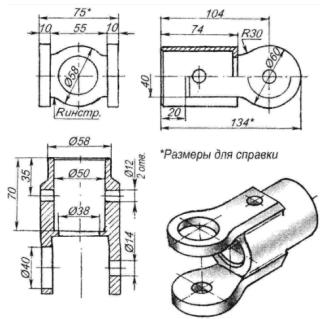
чертеж детали с необходимым числом видов, разрезов и сечений.
