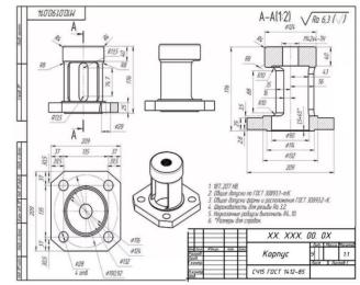
чертеж детали с необходимым числом видов, разрезов и сечений.
