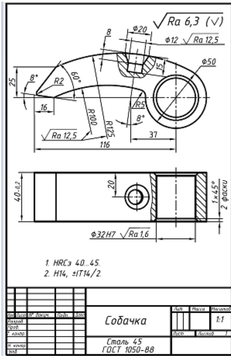
Дан чертеж. Постройте 3D модель детали с применением инструментов панели «Элементы тела», на 3D модели нанести размеры.
