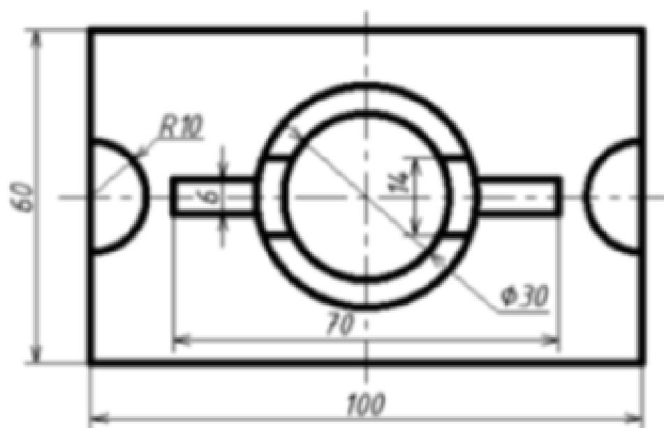
Дан чертеж . Постройте 3D модель с применением операций Ребро жесткости, Отверстие. На 3D модели нанесите размеры.
