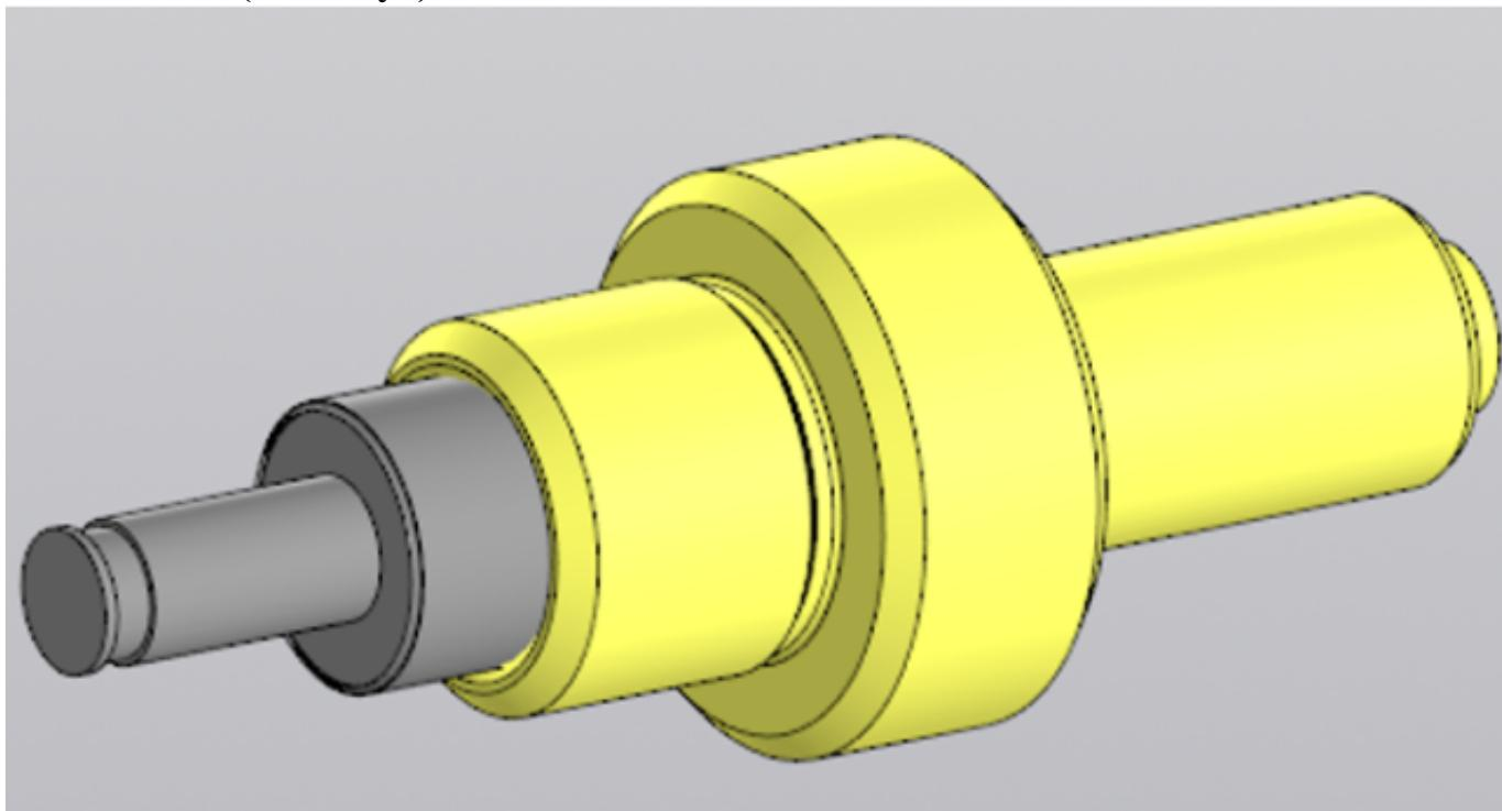
Дана сборка Клапан. Постройте ассоциативный чертеж выданной сборки с необходимыми разрезами, сечениями согласно ГОСТ 2.305-2008, нанесением размеров согласно ГОСТ 2.307-2011.
