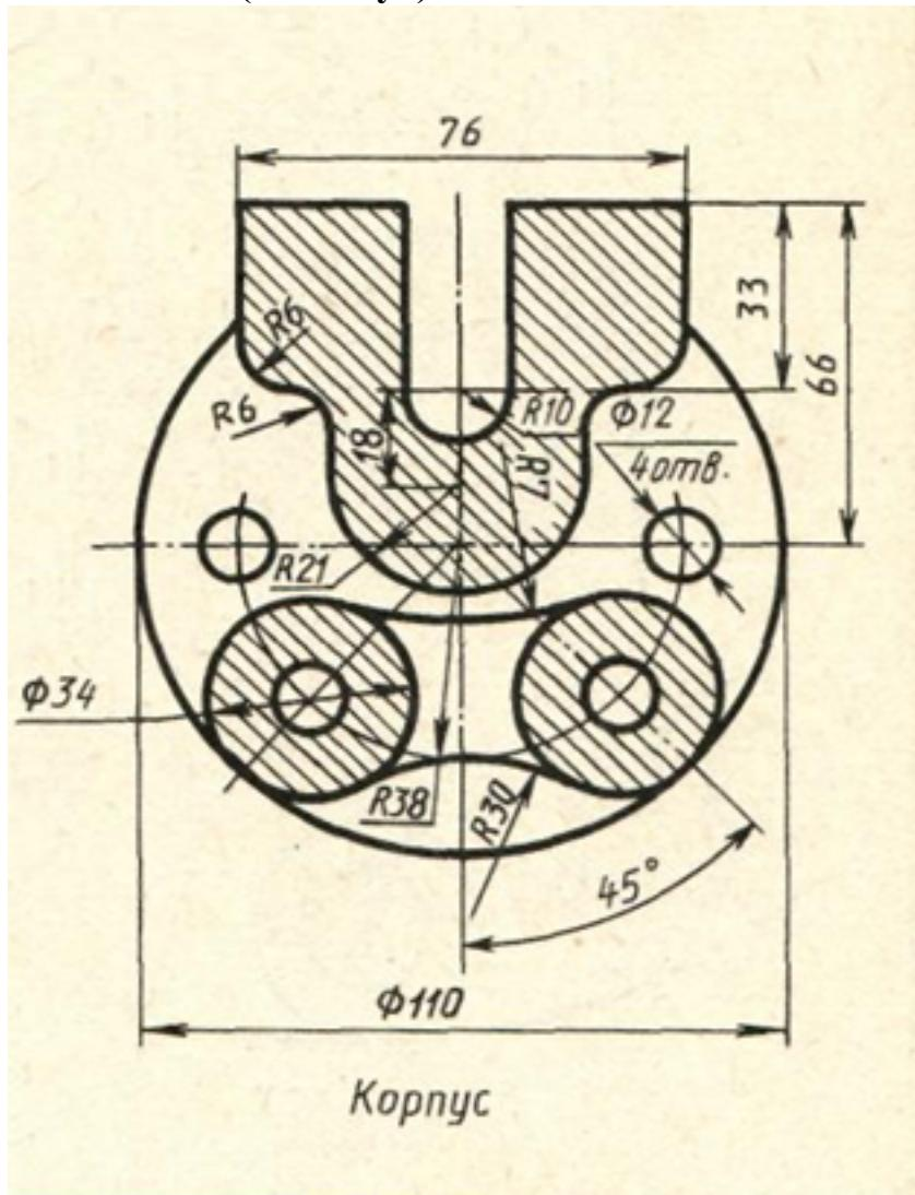
Дан чертеж (по вариантам). Постройте очертания контура плоской детали. Нанести размеры.
