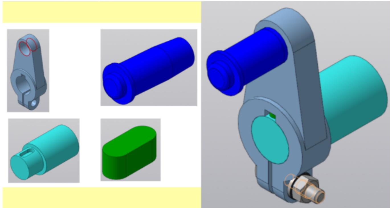
Даны детали, входящие в сборку узла "Кривошип". Соберите 3D модель сборки "Кривошип" и сформировать спецификацию.
