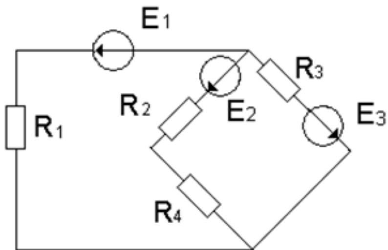
По заданной схеме электрической цепи: Определить число токов в схеме и выразить эти токи,
