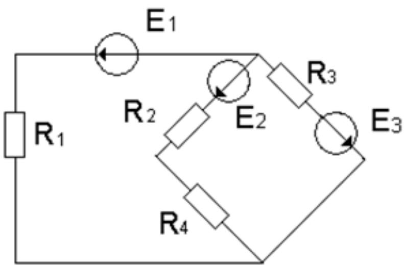
По заданной схеме электрической цепи определить какими методами можно рассчитать данную цепь. По структурному анализу схемы определить количество уравнений составленных: по методу законов Кирхгофа, по методу контурных токов и по методу узловых напряжений. Составить независимые уравнения при решении задачи методом законов Кирхгофа, применив правила
