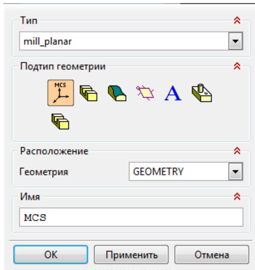
1. Назначение геометрии заготовки.
