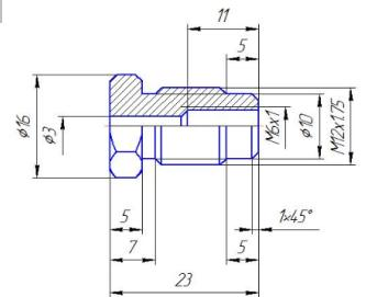
и на его основе произвести выбор токарного инструмента для обработки данной детали. Выбрать резцы для черновой, чистовой обработки и сверлильный инструмент, а так же сопутствующую инструментальную оснастку и данные для расчета режимов резания. Выбор производится из каталога фирмы Sandvik Coromant для токарного инструмента.
