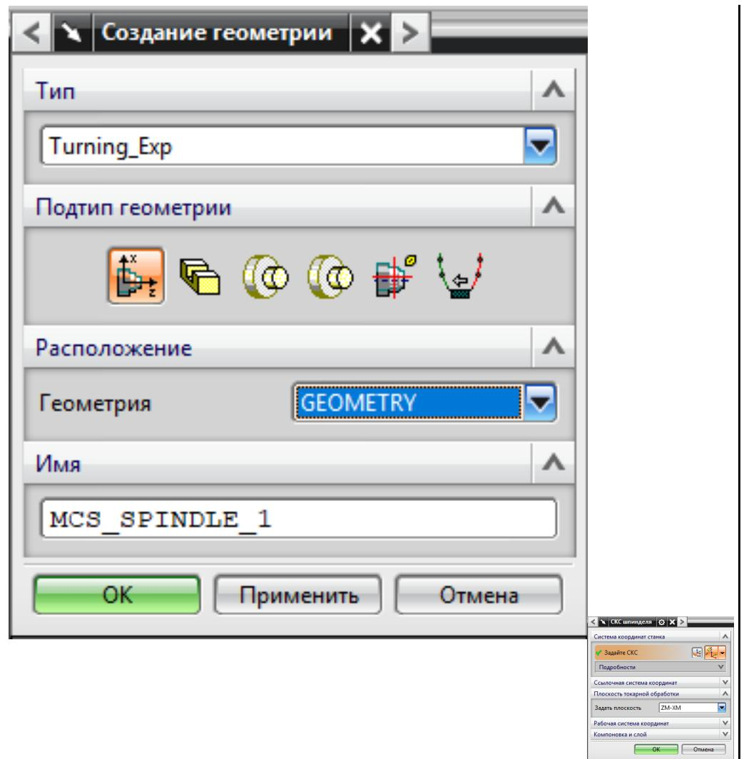
1. Назначение геометрии заготовки.
