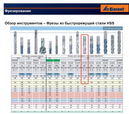
Выбор чистового инструмента по минимальному внутреннему радиусу на детали. При выполнении обкатки при чистовой обработке, диаметр инструмента может быть меньше номинального на 1-2мм;
