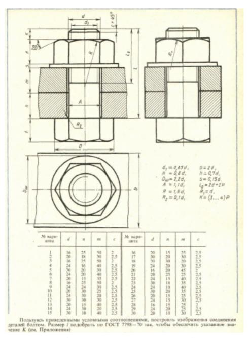
Построить изображение соединения деталей болтом. Размер L подобрать по ГОСТ 7798-70 так, чтобы обеспечить указанное значение К. При диаметре болта менее 20 мм построения выполнять в M 2:1, а при диаметре более 24 мм - в M 1:1
