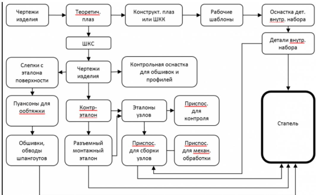
Составленная схема увязки для бесплазового метода
