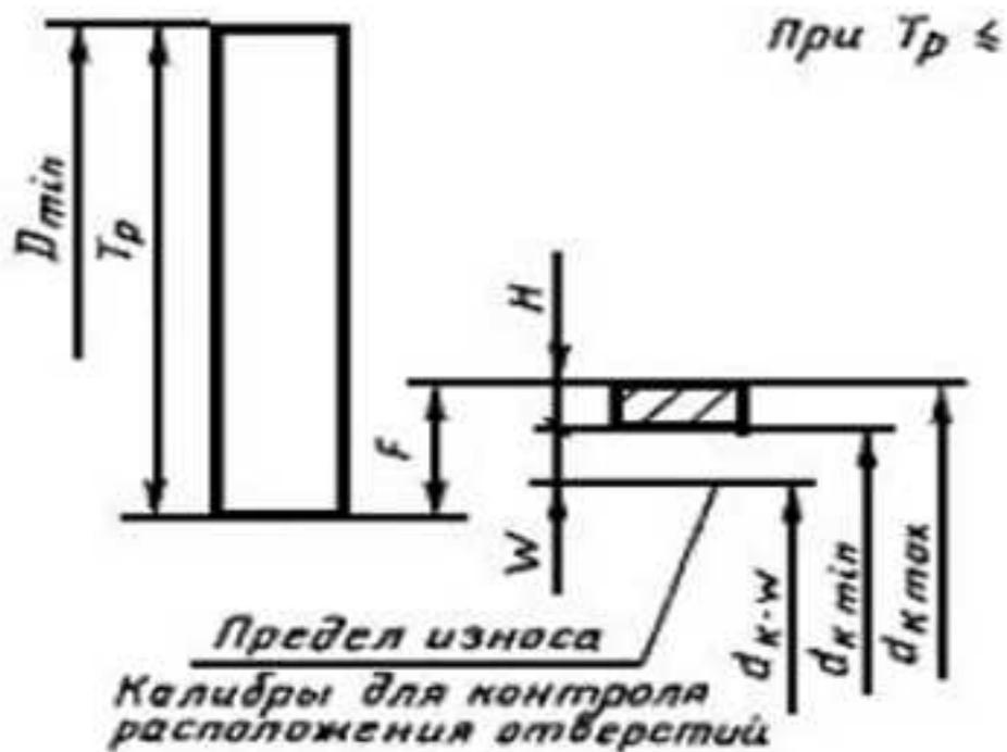
1. основное отклонение измерительных элементов калибра
