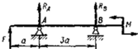
Составить уравнения равновесия для определения реакций связей приведенной балки.
