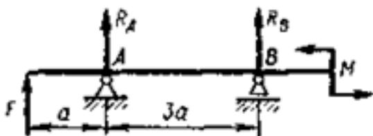
Составить уравнения равновесия для определения реакций связей приведенной балки.
