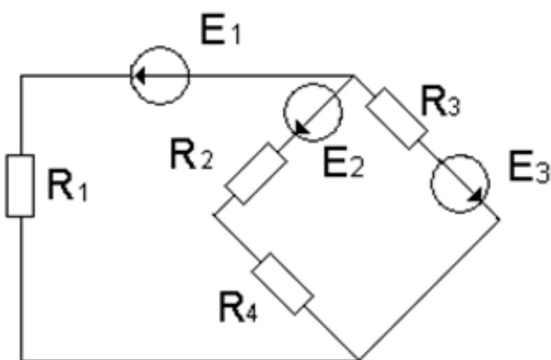
По заданной схеме электрической цепи определить какими методами можно рассчитать данную цепь. По структурному анализу схемы определить количество уравнений составленных: по методу законов Кирхгофа, по методу контурных токов и по методу узловых напряжений. Составить независимые уравнения при решении задачи методом законов Кирхгофа, применив правила составления уравнений. Указать контурные токи на схеме, составить независимые уравнения по методу
