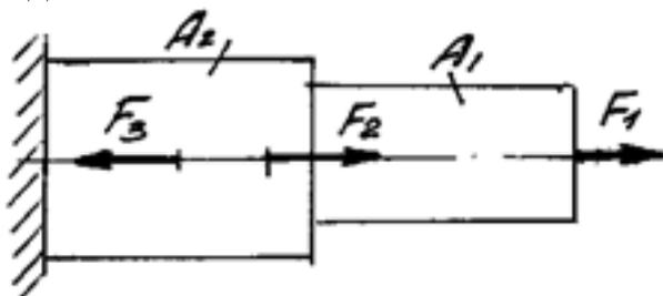
Выполнить расчет на прочность и жесткость каждого участка приведенного бруса, пользуясь построенными ранее эпюрами нормальных напряжений. (Приведен один
