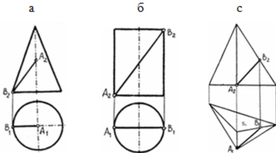
**25.** Отрезок прямой линии АВ, принадлежащий заданной поверхности, показан на чертеже
