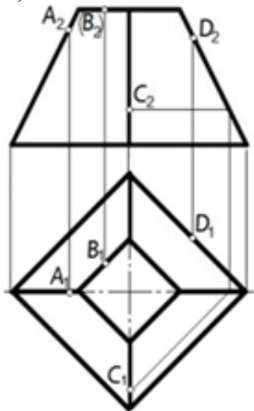
24. Отрезок прямой линии АВ, принадлежащий заданной поверхности, показан на чертеже
