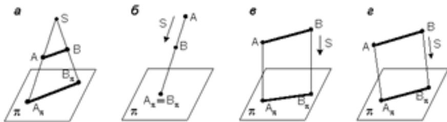
**4.** Вид проецирования, применяемый при построении плоских изображений пространственных предметов (машиностроительных чертежей):
