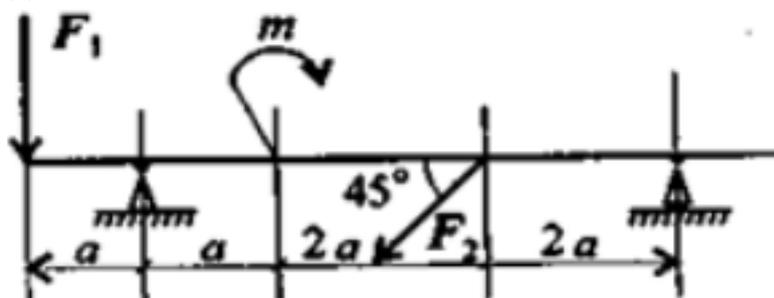
$$F_1=18\text{кН}; F_2=7\text{кН}; m=10\text{кН}\cdot\text{м}; a=0.3\text{м}$$
