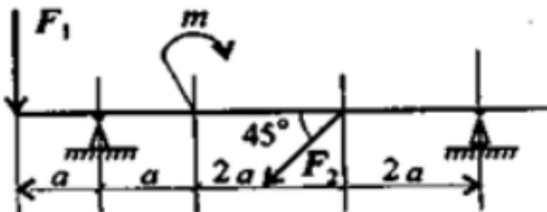
$$F_1=18\text{кН}; F_2=7\text{кН}; m=10\text{кН}\cdot\text{м}; a=0.3\text{м}$$
