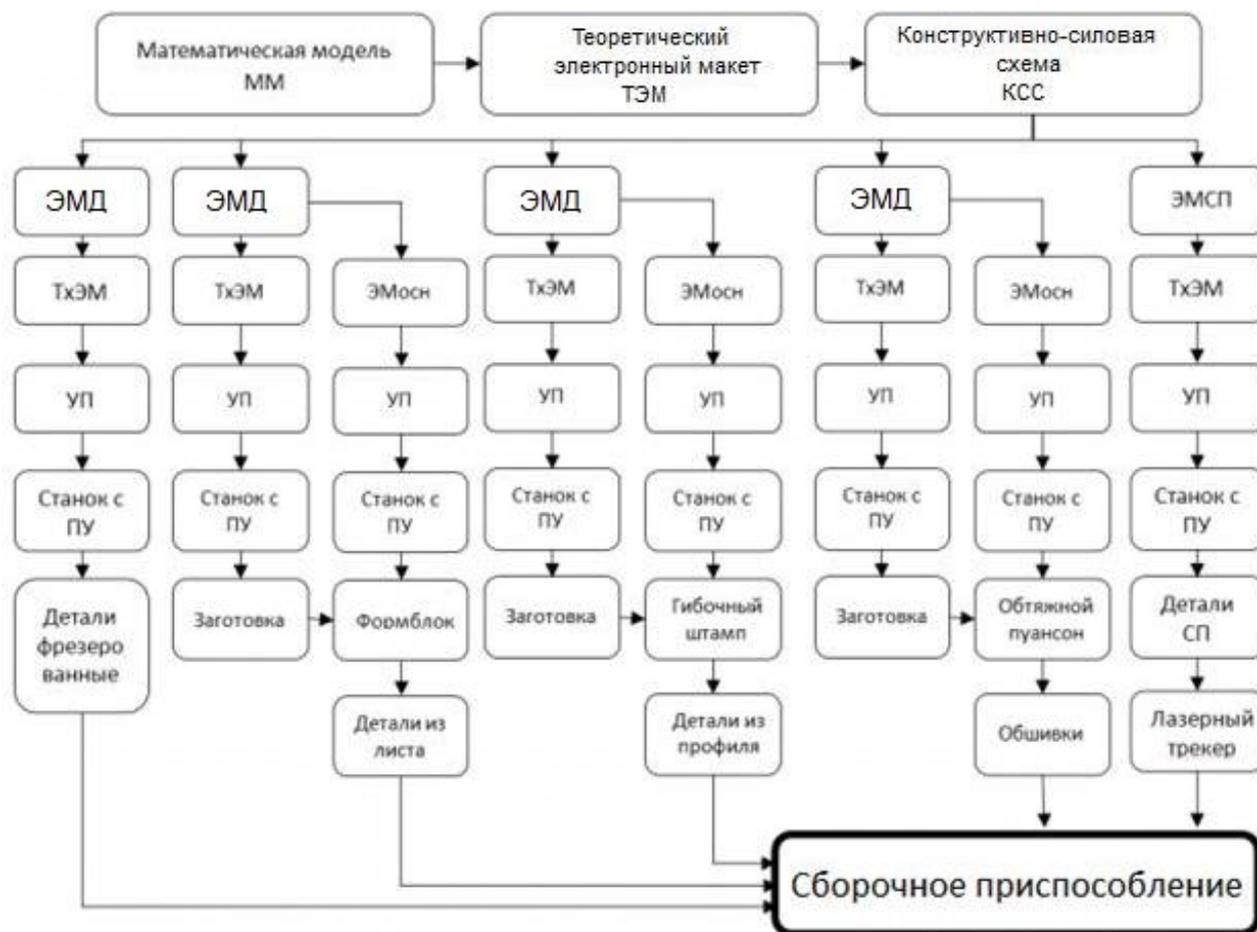
Рисунок 2.\_\_\_\_ – Схема увязки и обеспечения взаимозаменяемости
