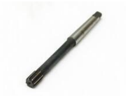
Рис. 30 2363-3404 Развертка \varnothing 9H7 BK6 ГОСТ 1672-80
