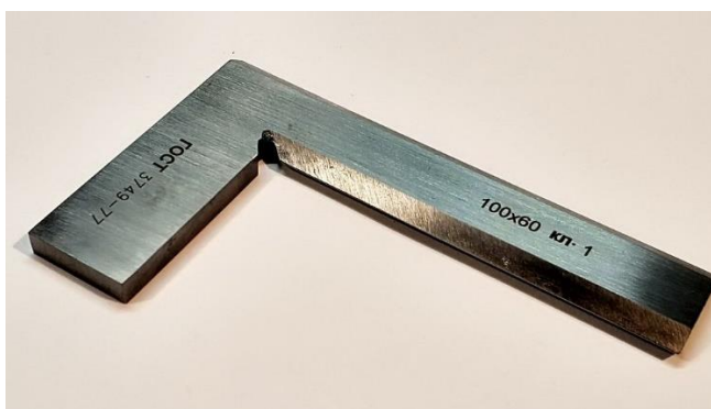
Рис. 46 Угольник УЛП 100х60 ГОСТ 3749-77
