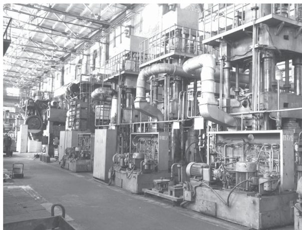
Рис. 61 Общий вид участка изотермической штамповки (вид сзади), оснащенного изотермическими установками, выполненными на базе гидравлических прессов с номинальной силой 6,3 МН (630 тс)
