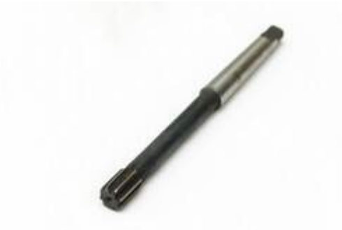
Рис. 35 2363-3404 Развертка \varnothing 9H7 BK6 ГОСТ 1672-80
