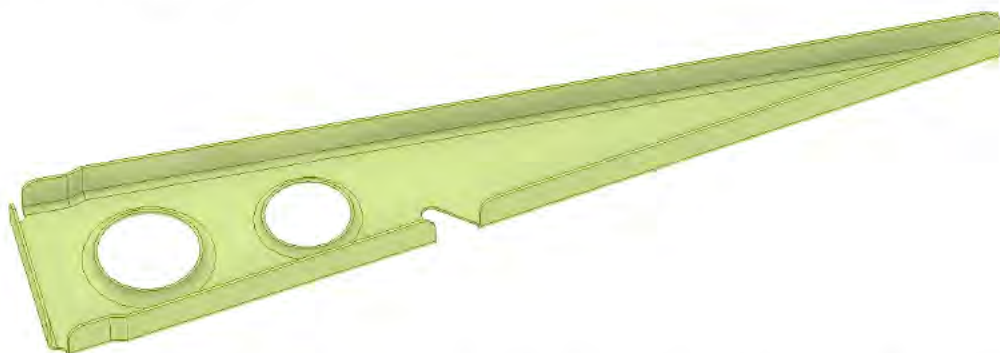
Рисунок 1.4 – Внешний вид хвостовой части нервюры закрылка самолета Су-25
