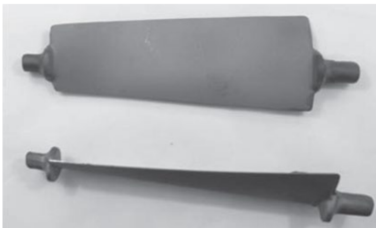
Рис. 63 Заготовки титановых лопаток авиационного двигателя, отштампованные в изотермических условиях
